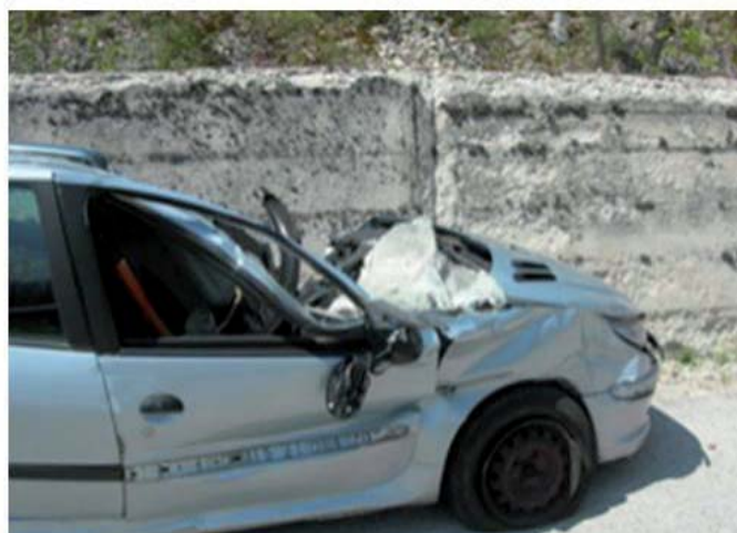
Figura 4 – Caduta di massi sulla strada provinciale per Ocre, sopra l'abitato di Fossa. Le aree di distacco dei massi sono situate sulle ripide pareti rocciose fratturate ed instabili lungo il perimetro dell'anfiteatro naturale, di origine carsica, sul cui fianco orientale sorge il paese
