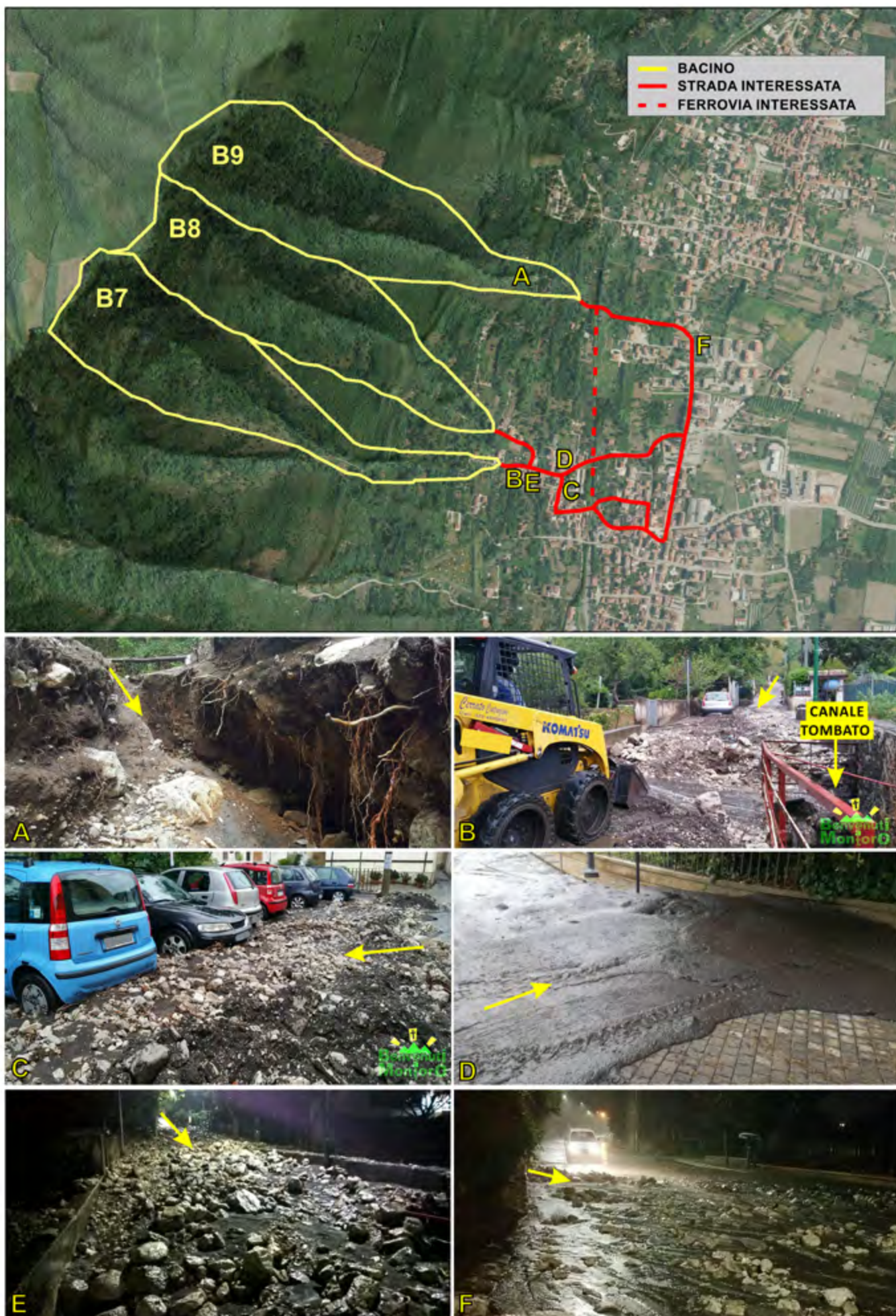
Figura 7. Panoramica dei bacini idrografici e dell'area urbanizzata interessata dall'invasione di flussi fangoso-detrिटici. Le immagini pubblicate dalla pagina Facebook "Benvenuti a Montoro" rappresentano l'erosione di un canale (A), ed i depositi di fango e detrito rinvenuti lungo le strade durante i diversi eventi (B,C,D,E,F)
