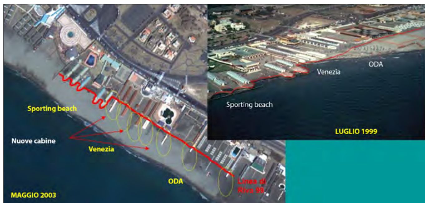
Figura 3a. Incremento superficie della spiaggia dopo il ripascimento del 1999 (Ostia levante)
