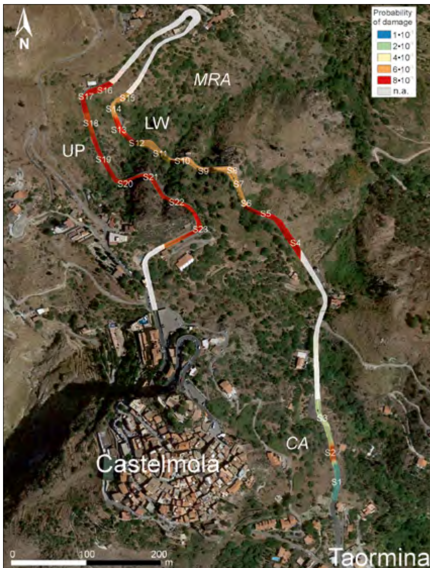
Figura 5. Mappa della distribuzione della probabilità di incidente sulla base di un evento di crollo (da Mineo et al., 2017)
