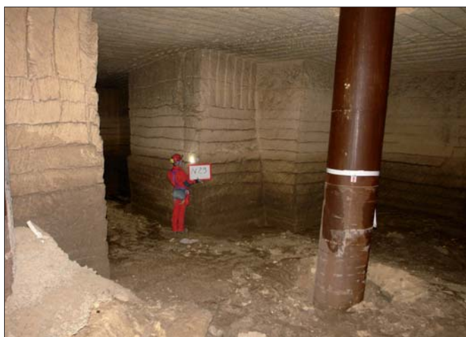
Figura 5 – Fase di rilievo speleologico con posizionamento mire
