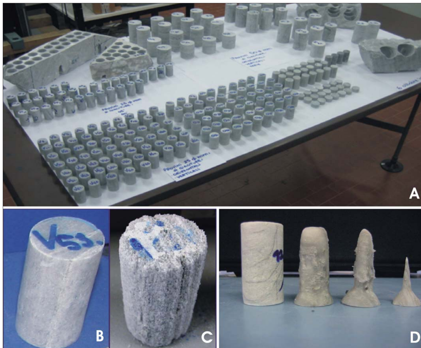
Figura 5 – Tavolo con provini; degrado gesso ed anidrite
