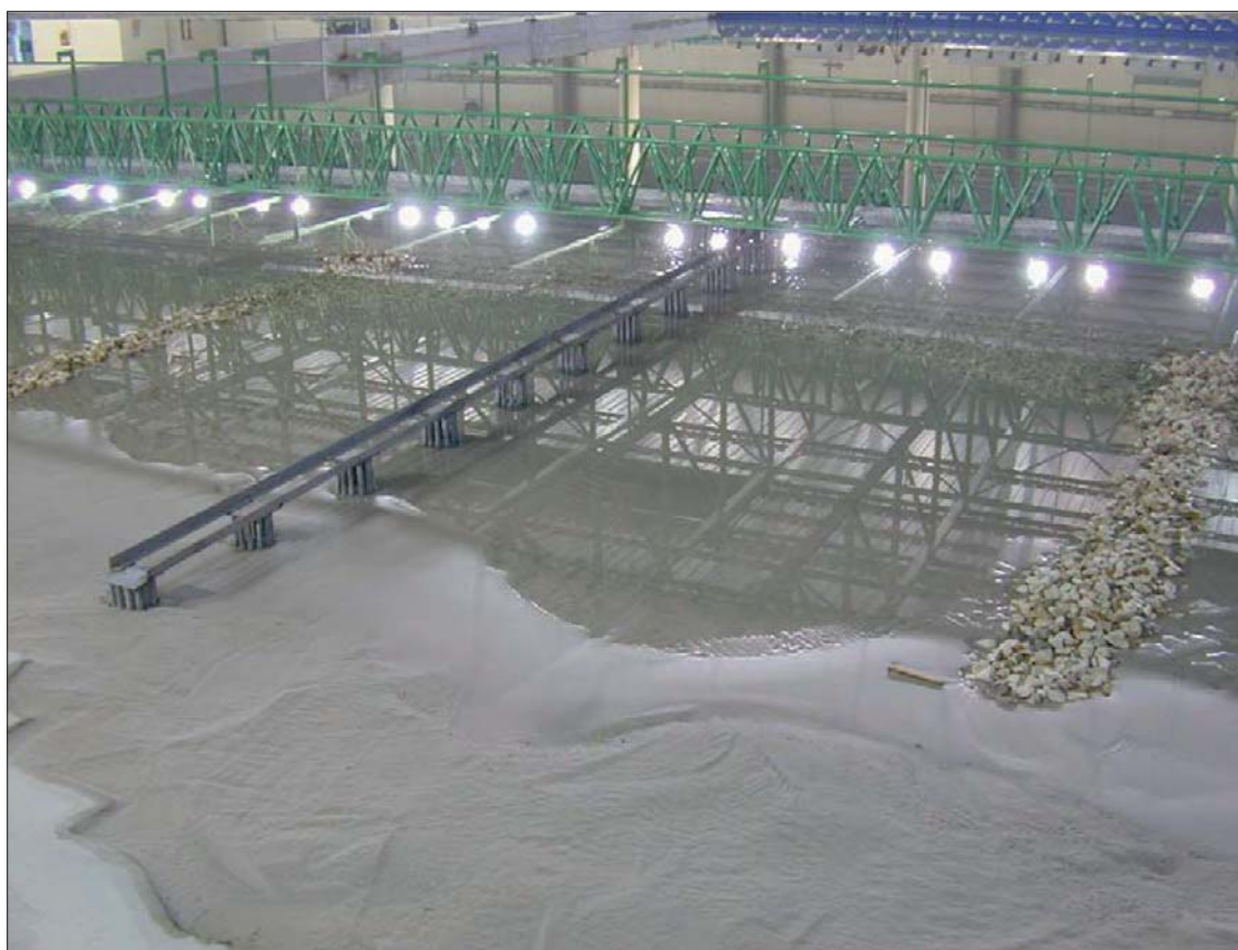
Figura 14 – Un esempio di modello fisico di opera di difesa costiera realizzato presso il LIC del Politecnico di Bari
