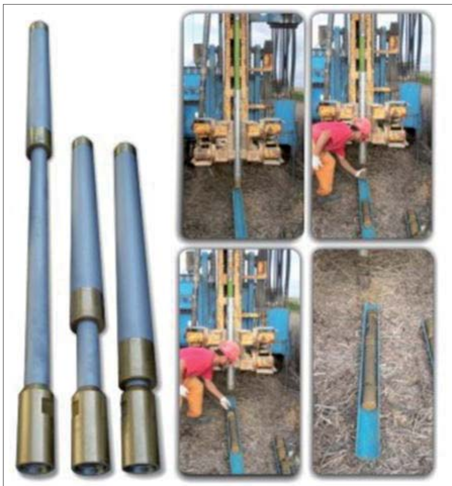
Figura 7 – Carotiere con estrattore a pistone idraulico
