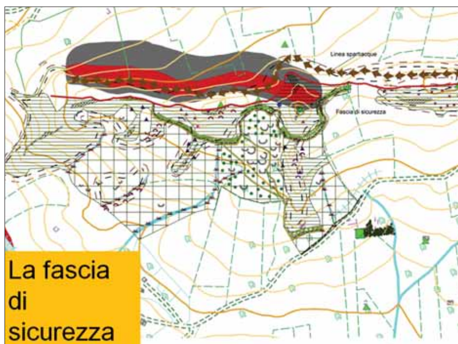
Figura 20 – Fasce di sicurezza per pericolosità e rischio geomorfologico dell'area di intervento
