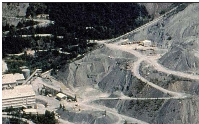
Figura 6 (a,b). Discarica lato Balangero, zona Est: modificazioni del territorio a seguito della messa in sicurezza delle superfici
