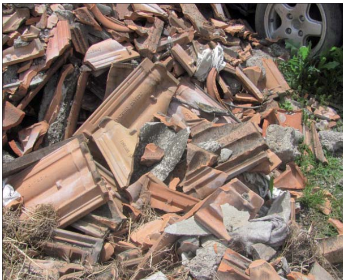
Figure 9-10. Abbandono sul suolo di rifiuti inerti frammisti a lastre in C/A (inseparabili)
