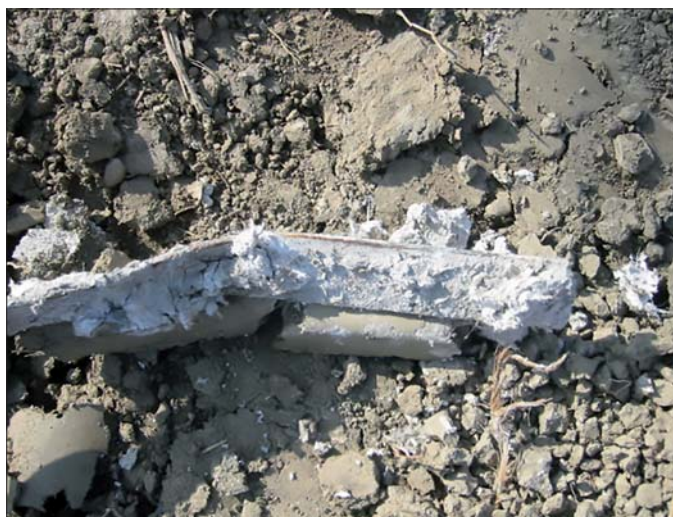
Figura 14. Residui di materiali isolanti provenienti da parti di impianto
