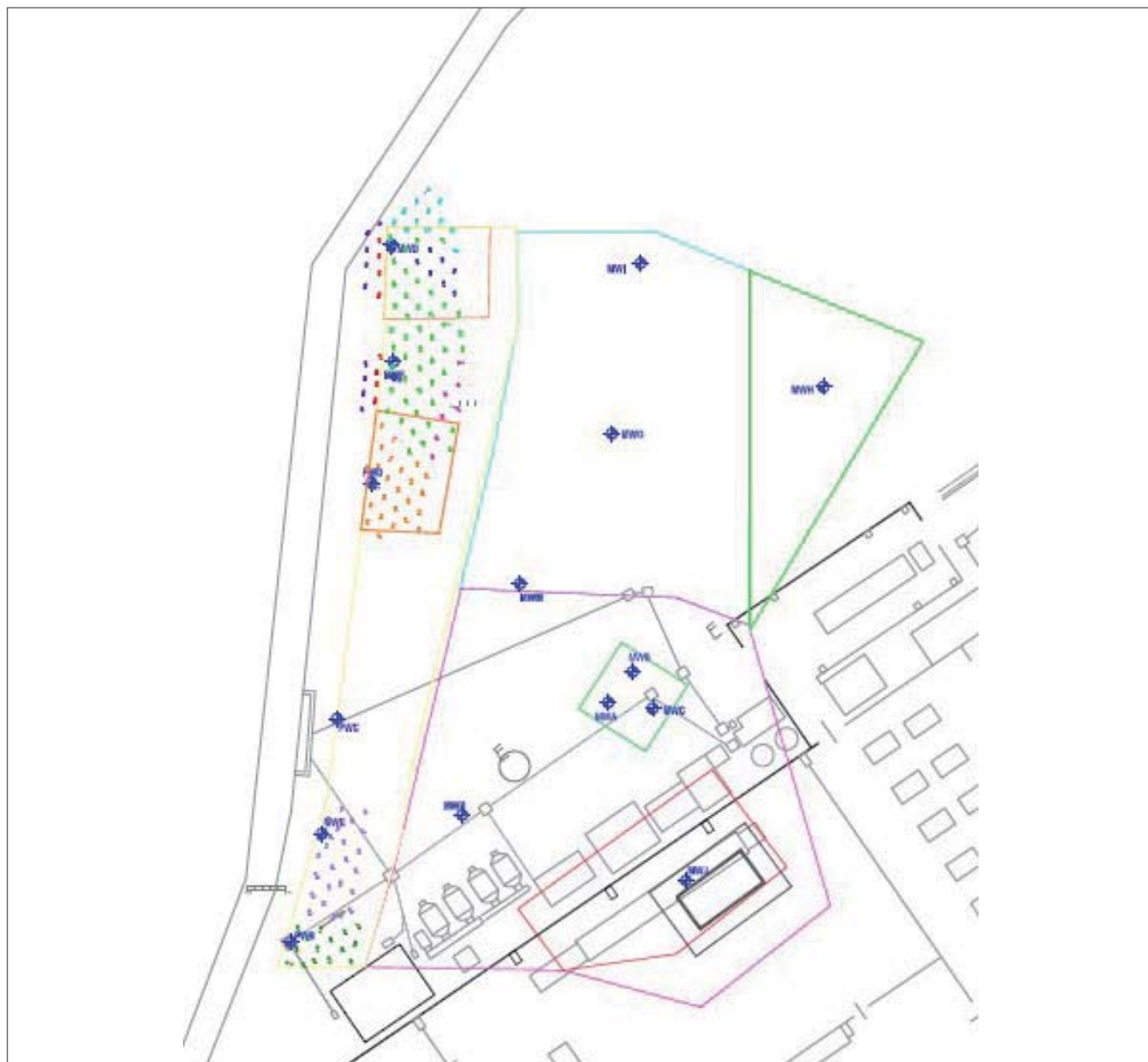
Figura 15. Configurazione dell'area di iniezione del PlumeStop®. Nella planimetria sono visibili anche le aree di iniezione ERD di Fase 1. Le diverse colorazioni dei punti identificano le diverse sotto-aree
