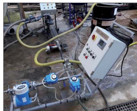
Figura 8. Dettaglio del sistema idraulico utilizzato per il trasferimento del concentrato di ELS dal fusto alle vasche di miscelazione e dalle vasche di miscelazione ai punti iniettivi. Nell'immagine è visibile anche la resistenza esterna applicata al fusto per il mantenimento del concentrato di ELS a una temperatura adeguata
