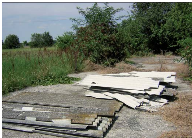
Figure 5-6: Abbandono sul suolo di lastre (sn) e di serbatoio (ds) in C/A frantumati sul suolo
