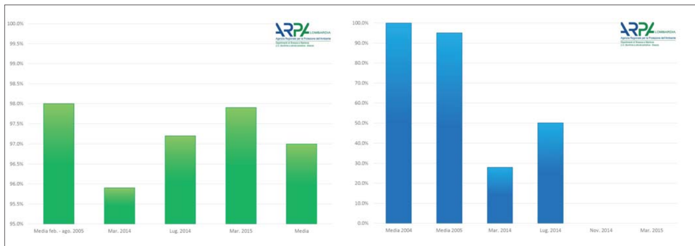
Figura 13. Efficienza di abbattimento del PCB nel pozzo 7 e del Mercurio nel pozzo 2
