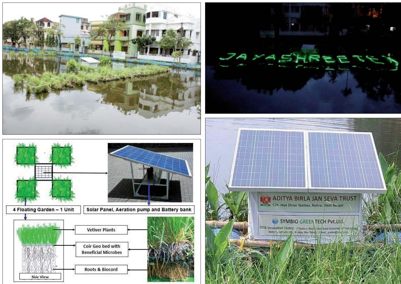
Figura 3. Da sinistra in senso orario; sistema di isole flottanti: visione diurna e notturna, schema strutturale di ogni unità modulare, pannello solare. Per gentile concessione di Biostarts Ventures
