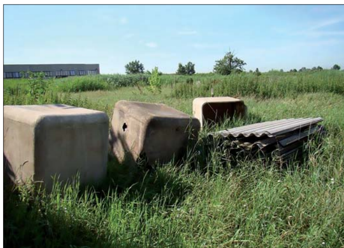
Figura 1. Abbandono di lastre e serbatoi in C/A integri
