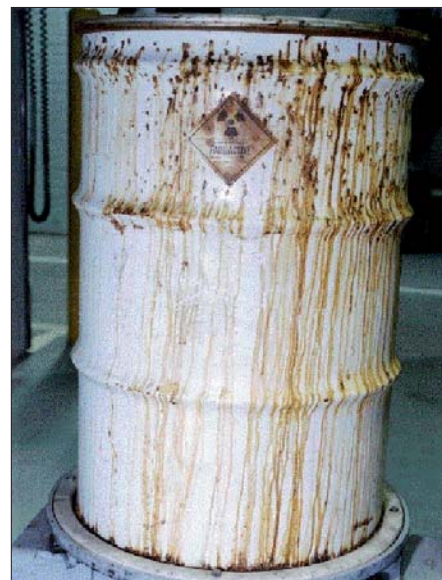
Figura 1. Esempio di fusto metallico con fori da corrosione
