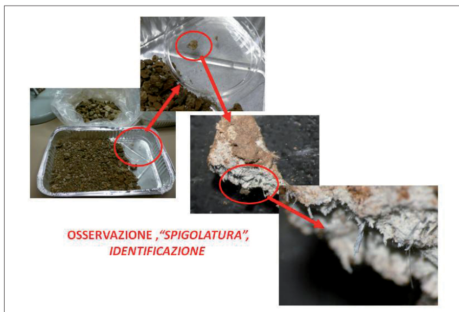
Figura 6a. Separazione ed identificazione fibre osservate
