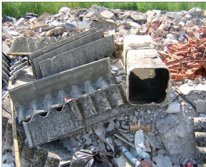
Figure 7-8. Abbandono sul suolo di rifiuti inerti frammisti a lastre in C/A (separabili)
