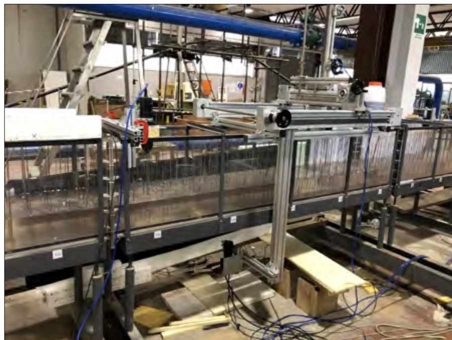
Figura 6. Canale del laboratorio di Idraulica del Politecnico di Bari, utilizzato per la sperimentazione dei flussi interagenti con la vegetazione
