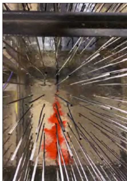
Figura 5. Esempio di un getto che si diffonde in una corrente in presenza di vegetazione rigida simulata con la presenza di steli di acciaio (laboratorio di Idraulica del Politecnico di Bari)
