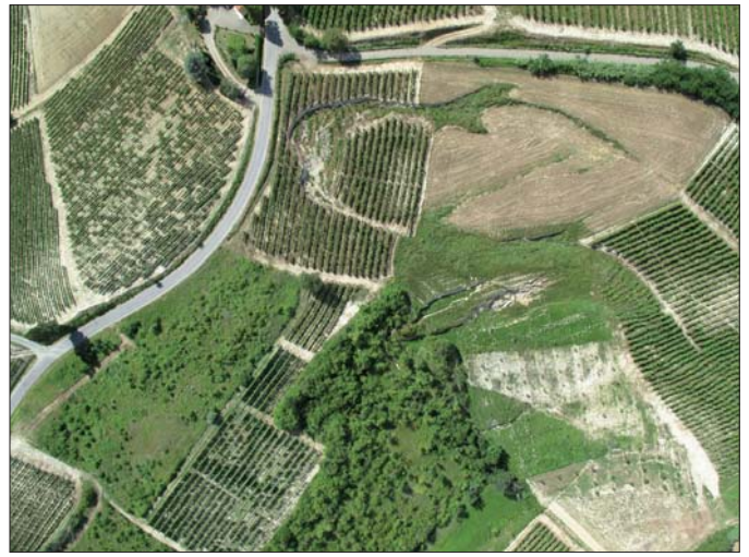
Figura 8 – Scivolamento planare a Castel Rocchero (aprile 2009). Ripresa aerea mediante volo U.A.V. (Unmanned Aerial Vehicle) – Convenzione Compagnia Nimbus/Protezione Civile Regione Piemonte.
