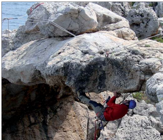
Figura 11 – Rilievo Geostrutturale in cordata
