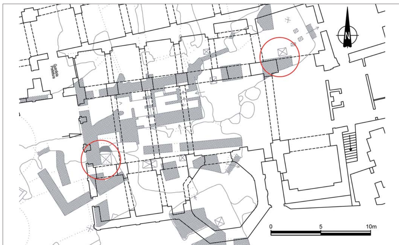
Figura 6 – Sovrapposizione tra la planimetria della chiesa-Prefettura e quella degli ipogei: i cerchi in rosso indicano le botole dalle quali è stata fatta la verifica della sovrapposizione.
