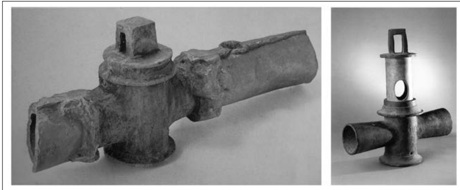
Figura 5 – Valvole in bronzo. A sinistra valvola in bronzo di grande diametro rinvenuta a Ostia Antica nelle Terme dei Nettuno, ancora saldata alla fistula in piombo (FASSITELLI 1972). A destra valvola in bronzo rinvenuta a Pompei (CIARALLO, DE CAROLIS 1999)
