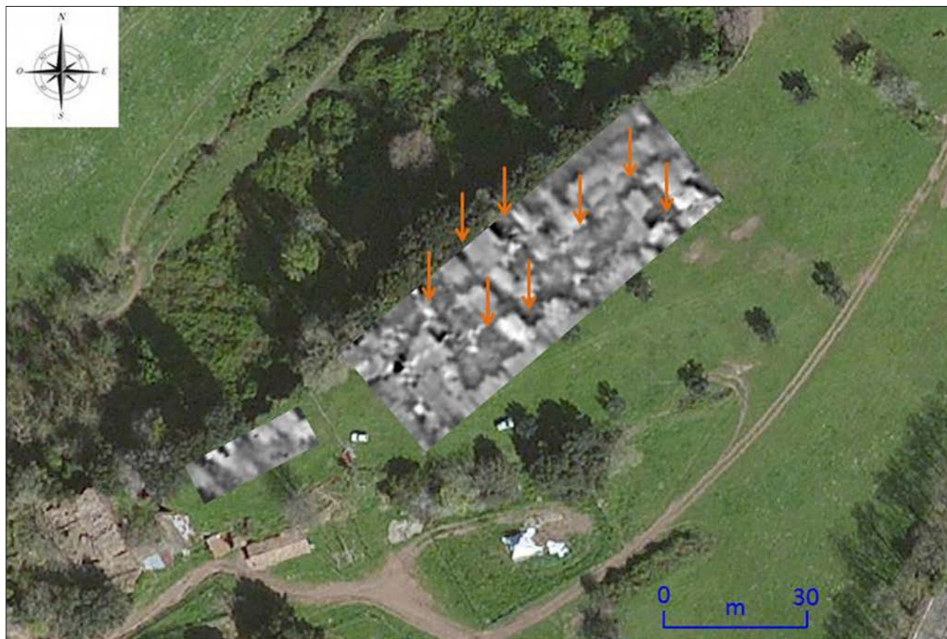
Figura 7a – Contour map del gradient della componente Z del CMT. Range -70 (nero), +140 (bianco) nT/m. Le frecce indicano alcune delle anomalie corrispondenti ai muri
