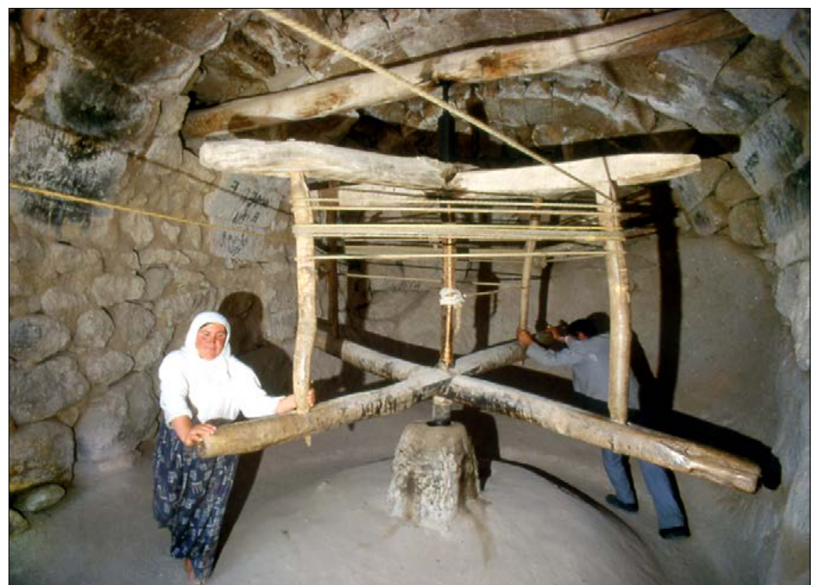
Figura 2 – Çekme, Derinkuyu (Cappadocia). Ruota per sollevare l'acqua di un pozzo collocato in un vano in muratura costruito in superficie (Foto M. Traverso)
