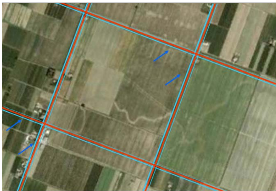
Figura 5 – Ricostruzione dell'impianto centuriale con le strade (rosso) e relativi canali di scolo (azzurro) in rapporto alla dimensione degli stessi
