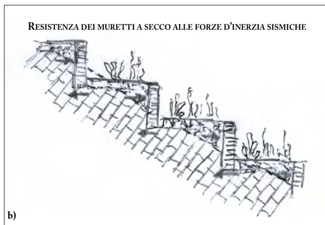
Figura 1. a) Tipica formazione calcarea con coltre detritica passibile di dilavamento, erosione e franamento durante un terremoto; b) Terrazzamenti con muretti a secco che rendono fertile il terreno e con la ripartizione delle masse prevenendo il franamento indotto dai terremoti
