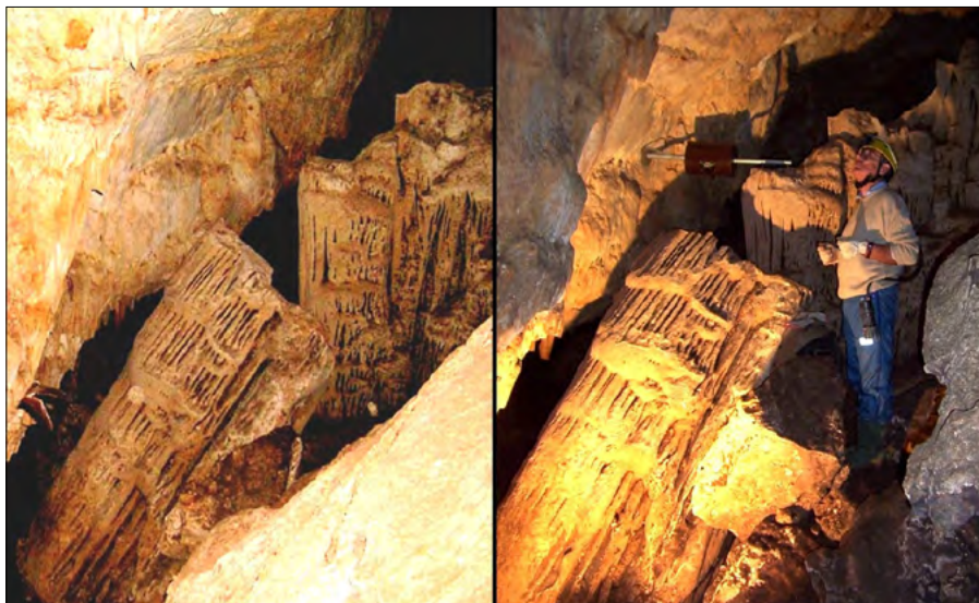
Figura 8. Sito della stazione NC 2 nella Grotta di Nove Casedde prima e dopo la messa in opera della stazione micrometrica (CGP0067, Martina Franca, Taranto)
