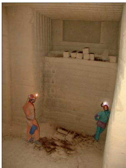
Figura 2 – Parete di attacco. In alto è presente la nicchia di escavazione e i conci estratti
