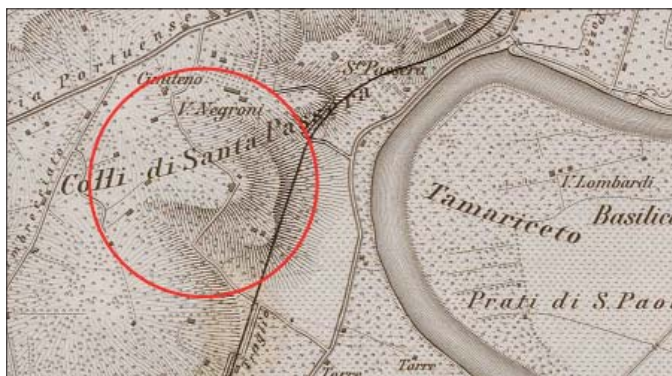
Figura 7 – Carta topografica di Roma e dei suoi contorni fino alla distanza di 10 miglia fuori le mura, indicante tutti i siti ed edifici moderni ed i ruderi antichi ivi esistenti: eseguita coll'appoggio delle osservazioni astronomiche e per mezzo della mensola delineata sulla proporzione di 1:25 000 / negli anni 1845 a 1846 / dal Barone di Moltke aiutante di campo di S.A. Reale il Principe Enrico di Prussia a Roma. (Helmuth Karl Bernhard Moltke, 1852, particolare, nel cerchio rosso l'area 1 esaminata)
