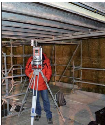
Figura 4 – Laser scanner RIEGL VZ400 e sue principali caratteristiche
