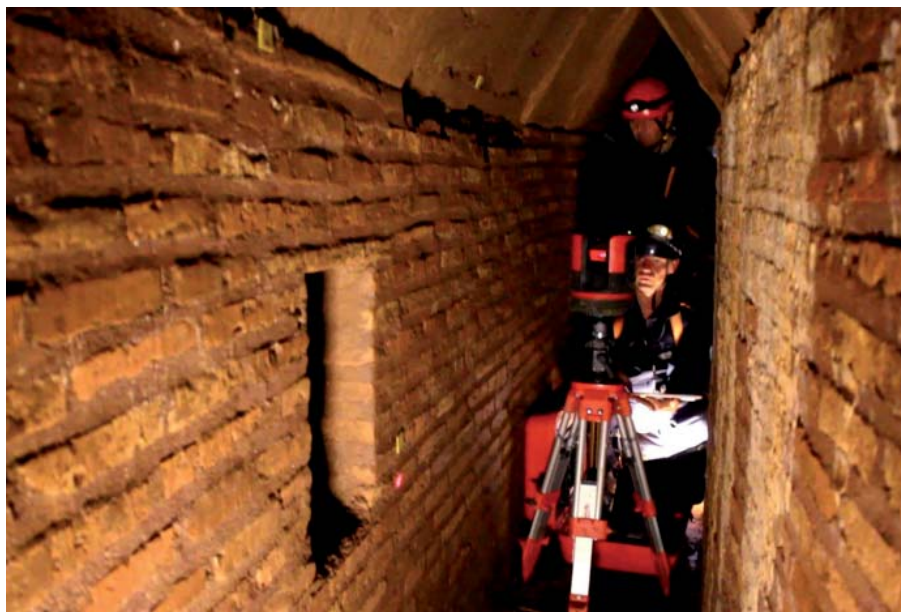
Figura 11 – Attività di rilievo con Leica Disto 3D dei condotti idraulici del Mausoleo
