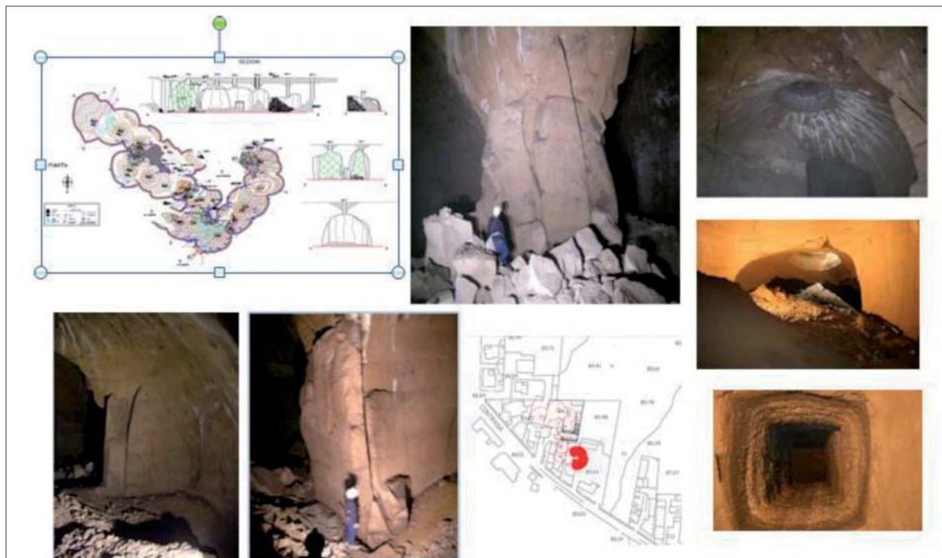
Figura 6 – Rilievo topografico e strutturale di cavità accessibili
