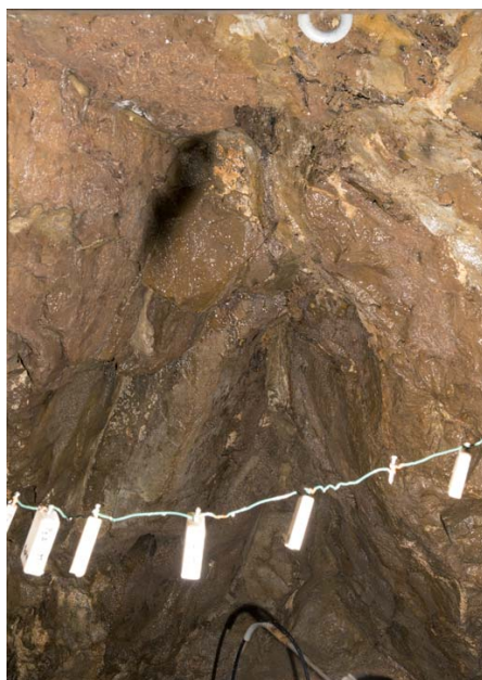
Figura 15 – Campioni di materiali diversi posti in ambiente estremo
