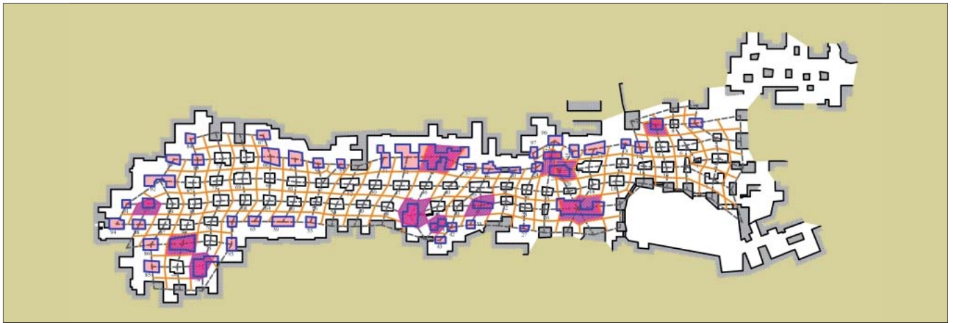
Figura 8 - Cava dismessa nei pressi dell'ex mattatoio di Mottola (TA): aree tributarie dei pilastri ottenute con il metodo degli interessi (in arancione); pilastri di confine con aree tributarie indeterminabili (in rosa); pilastri di grandi dimensioni intersecati dalle aree tributarie (rigato fucsia)
