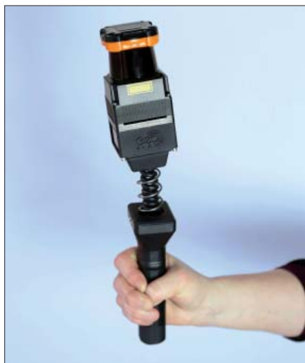
Figura 1 – Particolare della testina laser rotante del laser scanner mobile ZEB1 della Geoslam
