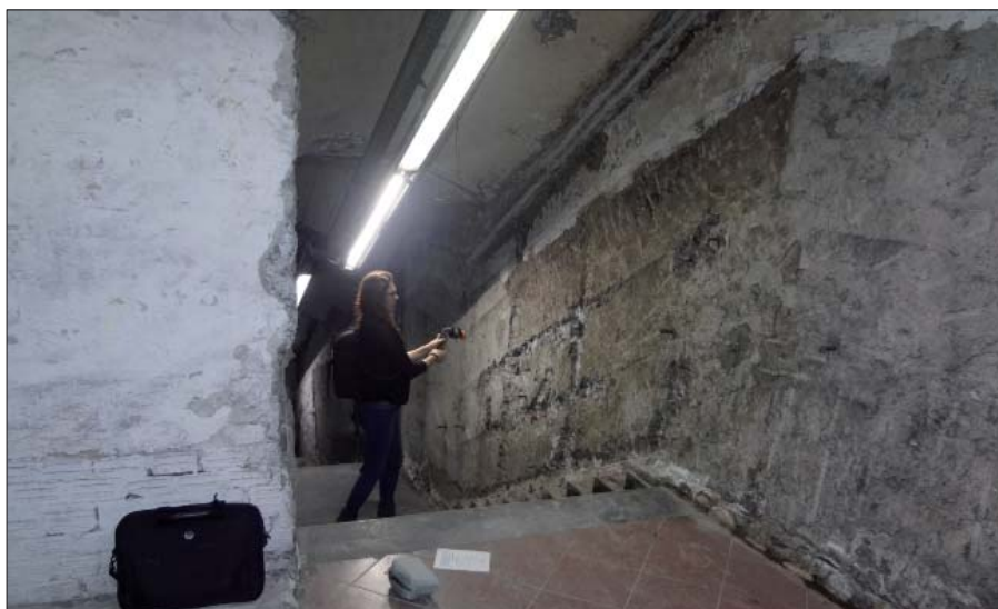
Figura 2 – Fase di acquisizione di ambienti di cavità artificiale con laser scanner mobile ZEB1
