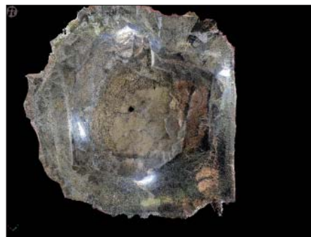
Figura 5 – Nuvola di Punti - Modello numerico reale dell'intera calotta
