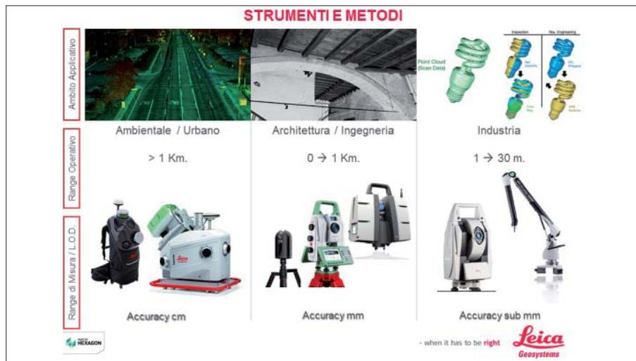
Figura 8 – Strumenti e metodi di rilievo
