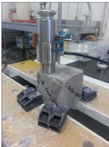
Figura 5 – Acquisizione sperimentale delle proprietà termiche (da De Lullo, 2016, tesi di laurea)
