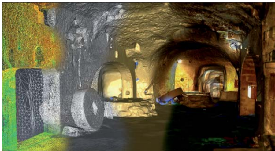
Figura 11 – Grotta delle Macine - Elaborazione dei dati 3d
