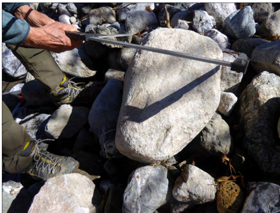
Figura 172. Alcune fasi delle campionature granulometriche mediante la tecnica del quadrillage lungo il T. Vermenagna a valle di Tetti Mecci (foto Luino).
