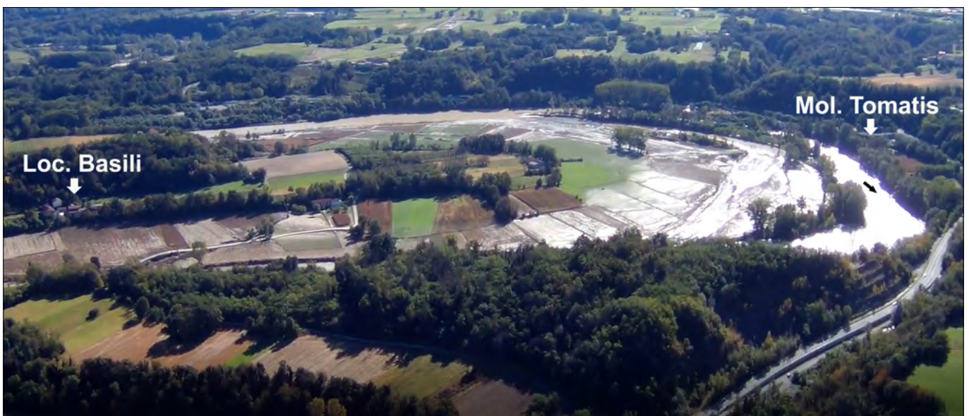
Figura 46. Comune di Cigliè. Lo scatto controluce mette chiaramente in evidenza le zone inondate dal Tanaro nella sponda interna (riva convessa), ove è stato depositato un rilevante strato di materiale sabbioso-limoso (frame da volo Olivotti).
