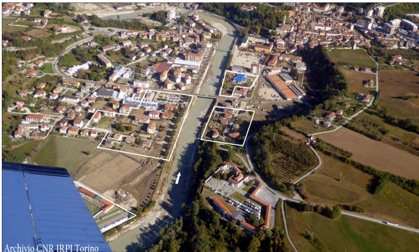
Figura 135. Panoramica aerea della ampia piana alluvionale di Ceva attraversata dall'alveo del Fiume Tanaro, la vera zona critica dell'abitato da un punto di vista idraulico. Le aree delimitate dal tratto bianco sono state edificate dopo il 1971 (cfr. carta di figura 132): si tratta di ville, case a schiera, piccoli condomini, attività artigianali e persino una scuola materna (tetto blu) che sono state pesantemente alluvionate nel 1994 e in misura minore nel 2016 e 2020 (foto Luino).
