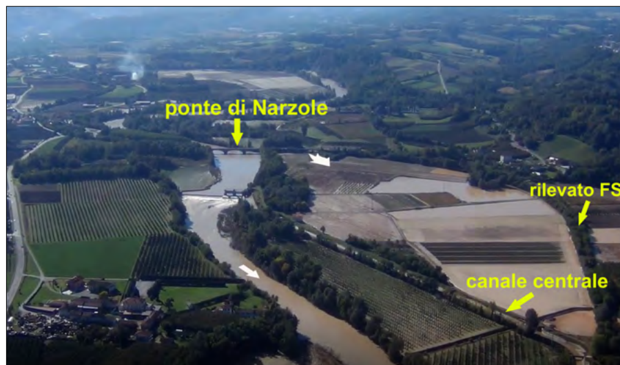
Figura 60. Narzole. Ponte della SP661 con il fornice sul proprio lato sinistro che ha consentito il deflusso regolare sul piano campagna delle acque esondate a monte dell'opera di attraversamento. A valle di esso, le acque hanno addirittura superato il rilevato ferroviario e invaso il canale della centrale Enel di Isorella (frame da volo Olivotti).
