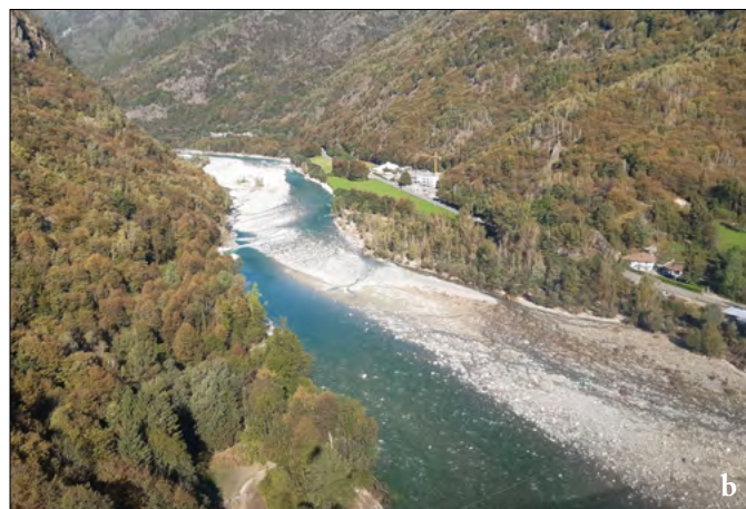
Figura 223. Località Balangera, confronto tra la situazione precedente (a) e post evento (b). Si noti la completa asportazione delle isole e barre laterali: l'acqua ha occupato tutto il corridoio fluviale con profonde erosioni di sponda e di fondo.
