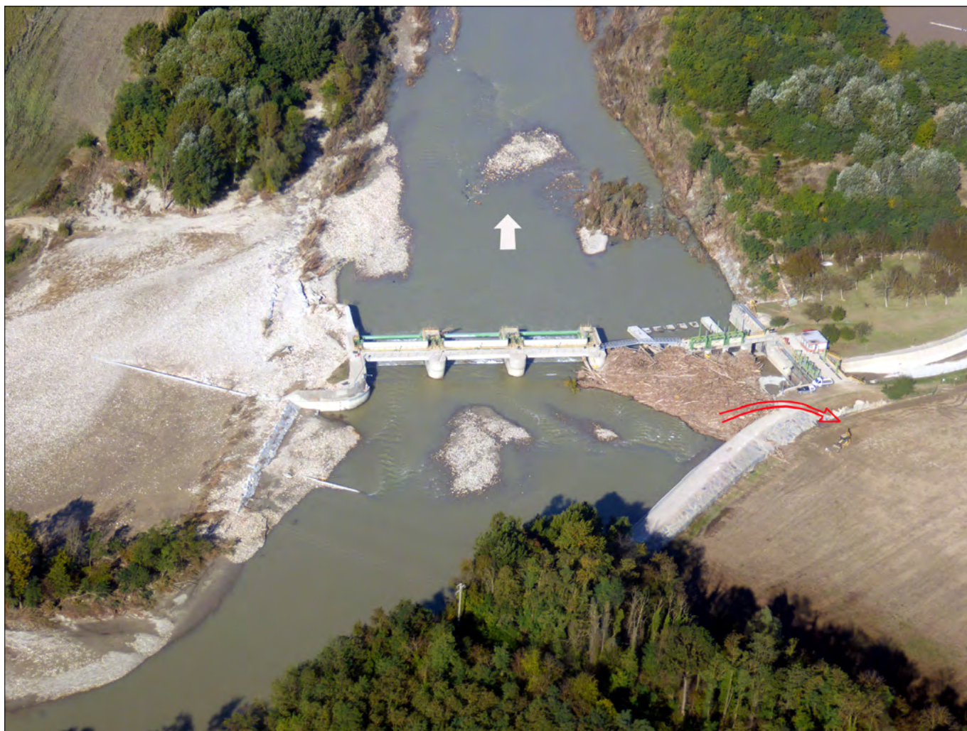
Figura 56. Volo aereo dell'8 ottobre 2020: traversa di derivazione di Clavesana parzialmente intasata dalla presenza di materiale flottante (foto Turconi).
