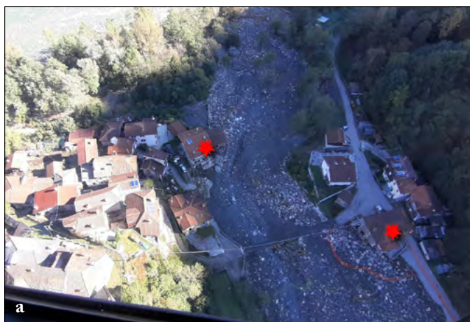
Figura 235. Morca (VC): a) fotografia da elicottero di frazione Solivo, in evidenza gli edifici danneggiati; b) l'Osteria dei Cacciatori il cui edificio è stato danneggiato dall'acqua e dai massi trasportati dalla corrente; è stato inoltre asportato in parte il parcheggio a monte.
