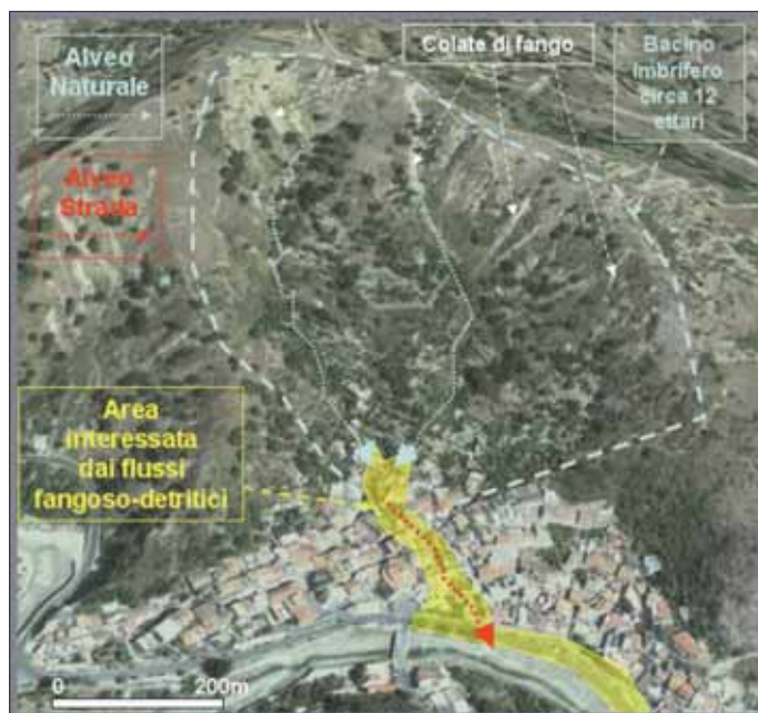
Figura 4 – Colate di fango verificatesi nel bacino a monte di Mili San Marco tra il 1 ottobre 2009 e il 10 marzo 2010. A destra è illustrata l'area di Mili San Marco (foto del 2006; a sinistra (foto dell'agosto 2010) sono evidenti le varie colate di fango che si sono innescate ed evolute lungo i ripidi versanti a monte dell'abitato riversandosi lungo le strade, tra il disastroso evento del 1 ottobre 2009 e quello del 10 marzo 2010.
