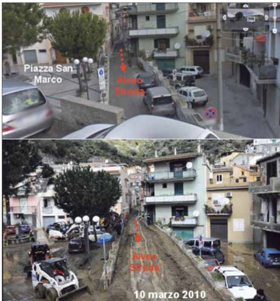
Figura 6: La Piazza San Marco (in alto, prima, e in basso, dopo, l'evento) invasa dai detriti trasportati dai flussi rapidi alimentati dalle colate di fango che si sono innescate ed evolute lungo i versanti a monte dell'abitato.
