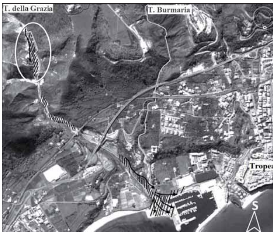
Figura 10 – Torrente della Grazia: il cerchio indica l'ubicazione dell'impianto di depurazione che sbarrava completamente il naturale deflusso delle acque. Il rigato indica le aree alluvionate e le frecce la direzione della corrente di piena.
