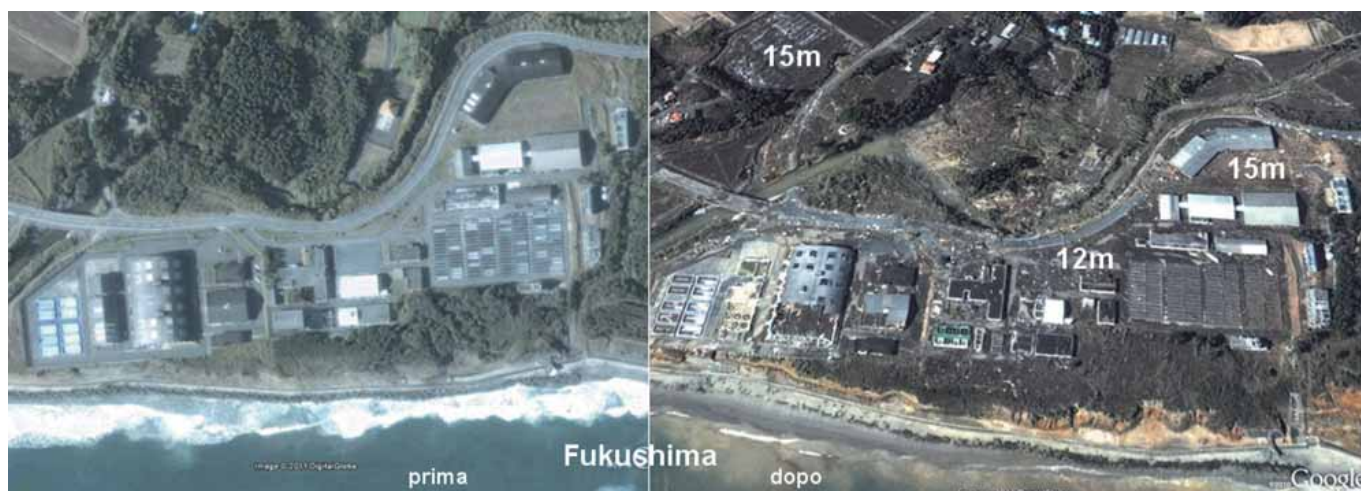
Figura 13: L'area di Fukushima devastata dallo tsunami fino all'altezza di oltre 15 m, oltre il doppio del massimo run up previsto.
