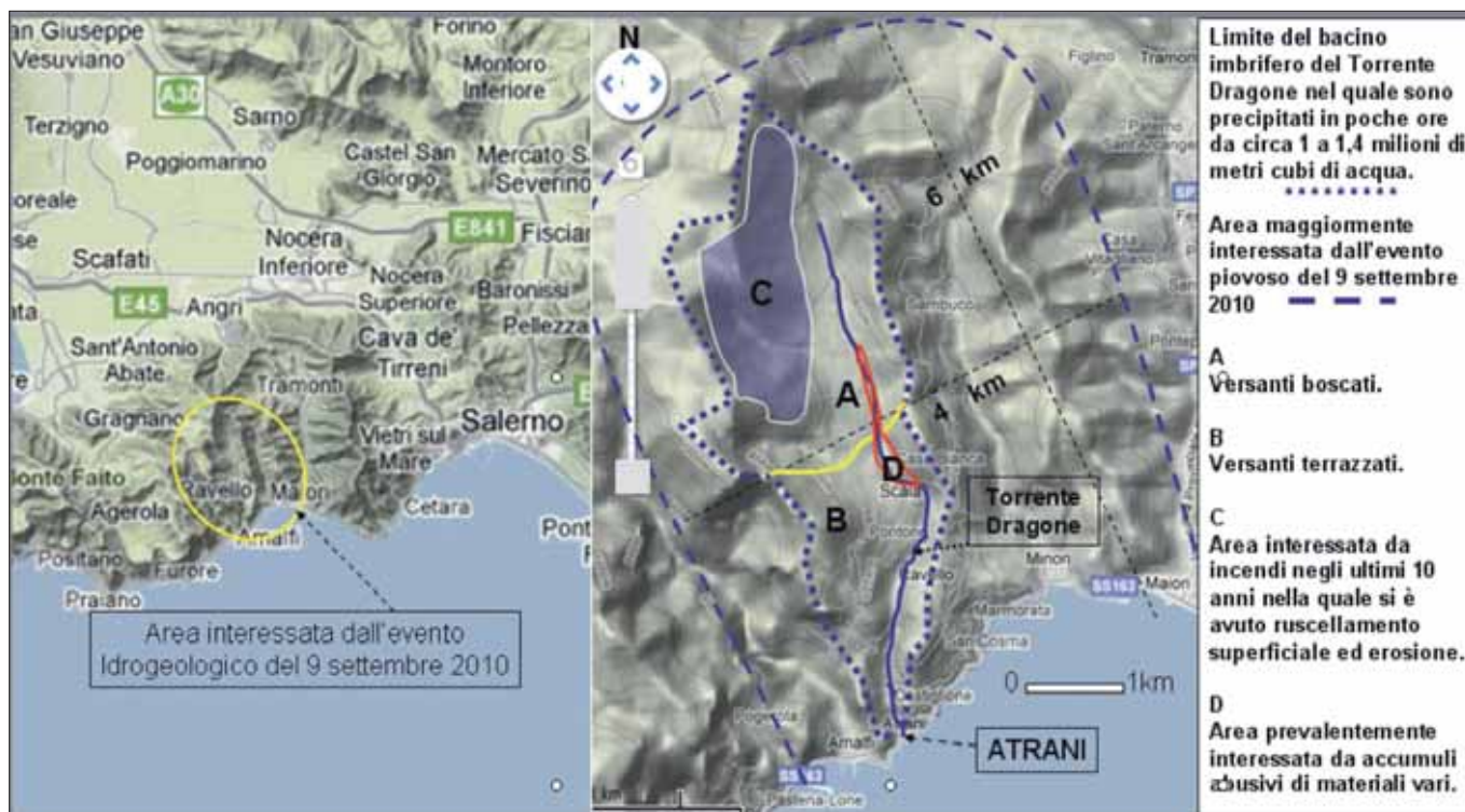
Figura 20: Quadro ambientale del bacino imbrifero a monte di Atrani. Dalle parti di versante interessate da incendi negli anni passati si sono innescati accentuati fenomeni erosivi che hanno dato origine al flusso fangoso detritico che ha invaso l'alveo strada di Atrani con portata massima stimata superiore a 100 metri cubi/secondo.
