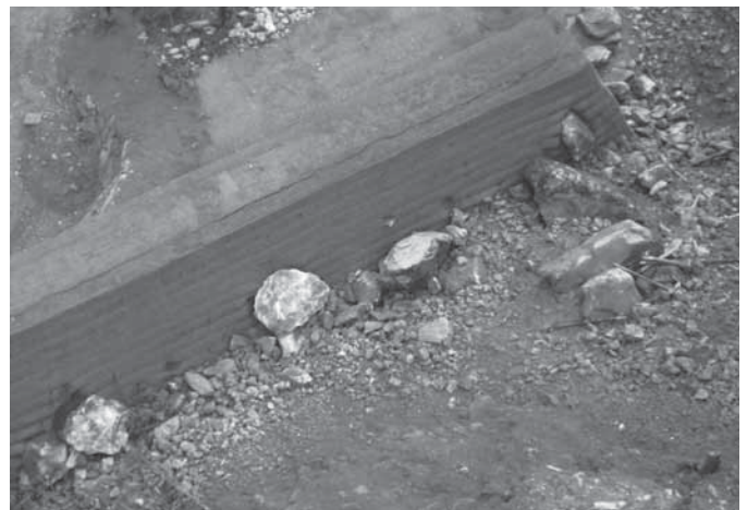
Figura 9. Paramento di valle del rilevato (non si osservano deformazioni dovute all'impatto dei blocchi sul paramento di monte).
