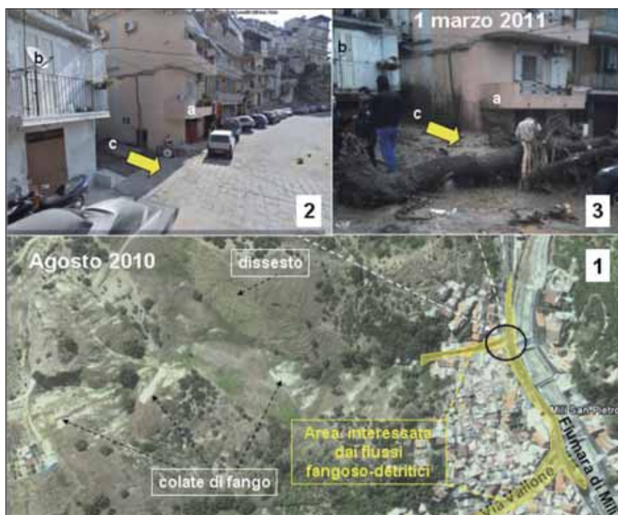
Figura 11: La parte orientale dell'abitato, lungo la Strada Provinciale, individuata con il cerchio nero nella foto 1 in basso, invasa da fango, detriti e alberi d'alto fusto trasportati da colate di fango innescatesi ed evolutesi nel bacino a monte, che era già stato interessato da colate tra il 1 ottobre 2009 e il 10 marzo 2010, ed incanalatesi nell'alveo strada indicato con c nelle foto in alto. La foto 2 e 3 mostrano lo sbocco dell'alveo strada rispettivamente prima e dopo l'evento del 1 marzo 2011. Le lettere minuscole indicano i punti di riferimento nelle foto 2 e 3.
