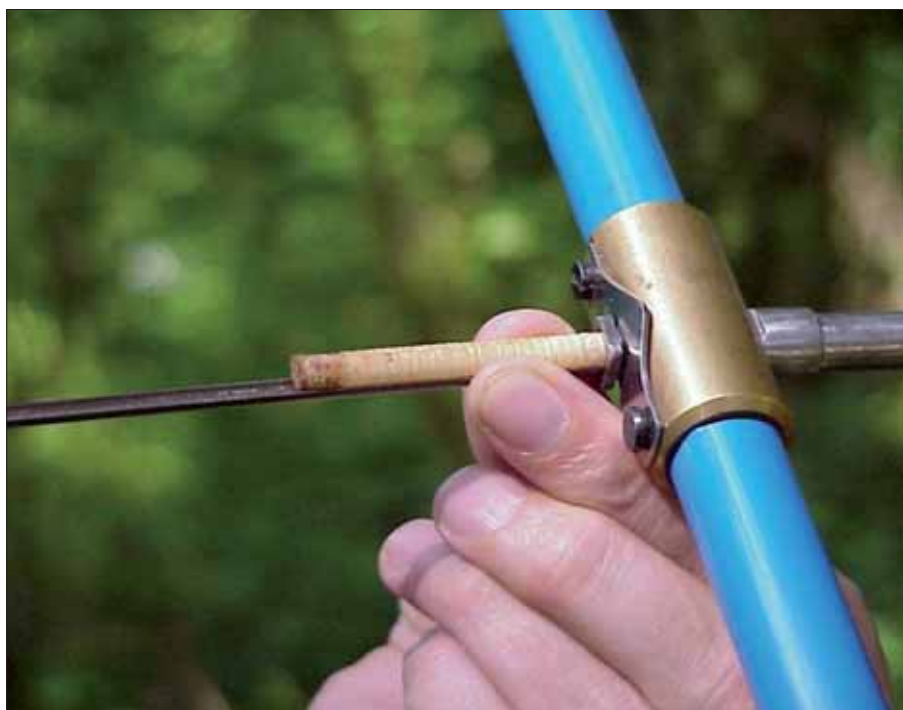
Fig. 6 – Campionamento non distruttivo con carotatore di Pressler
