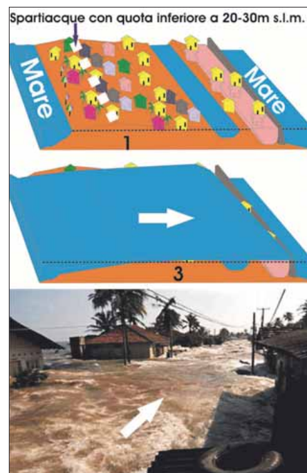
Figura 2 – Schema tridimensionale che evidenzia la catastrofica invasione di un'area emersa, delimitata dall'Oceano sui due lati (schema in alto), quando l'altezza dell'acqua riversata sulla terra ha superato lo spartiacque e si è incanalata rovinosamente, in discesa, lungo il versante opposto (schema in basso), come accaduto nella città di Banda Aceh nella parte settentrionale di Sumatra e in molte altre zone abitate costiere lungo le aree depresse dell'India, Sri Lanka, Thailandia e Indonesia.
