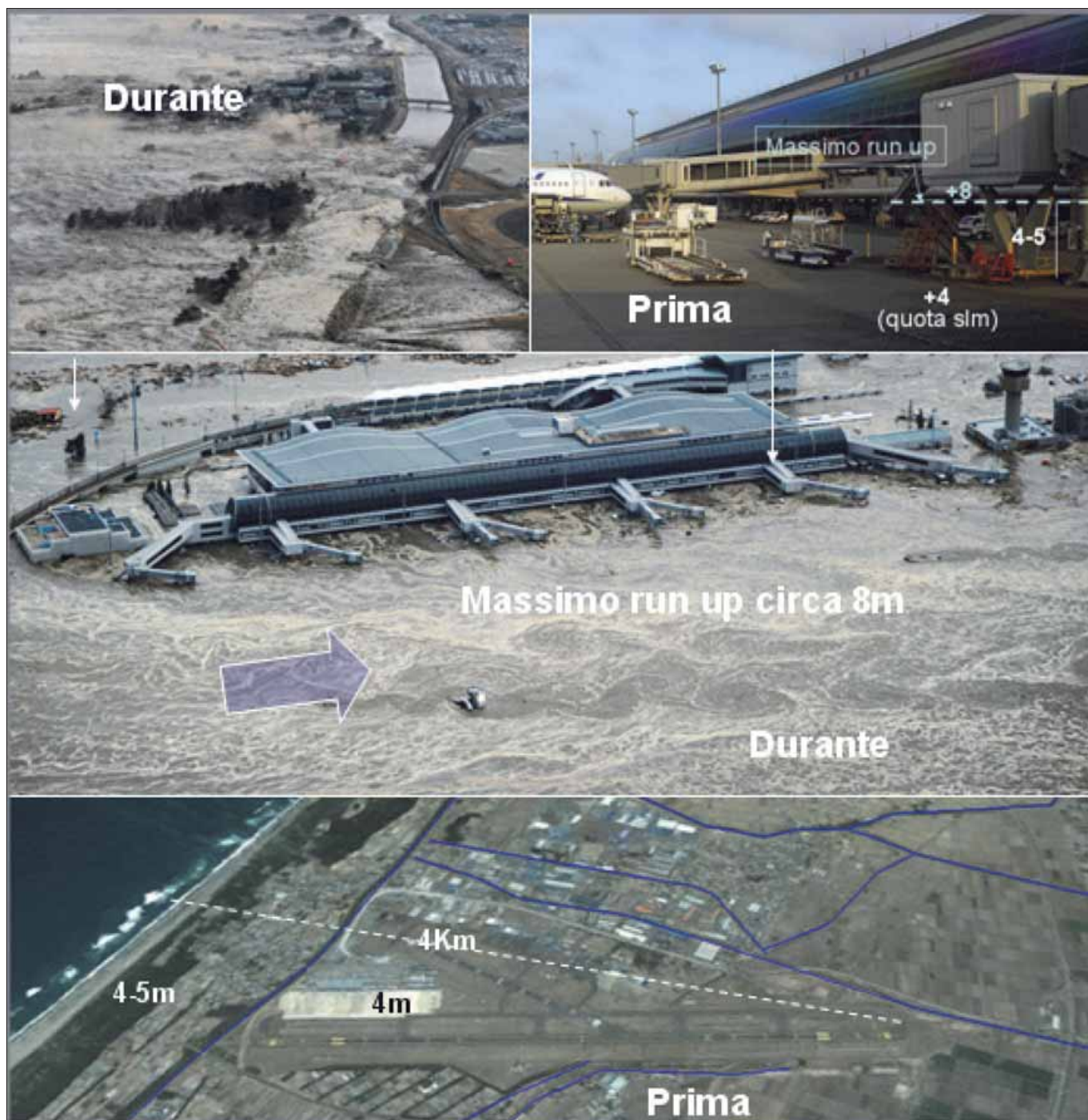
Figura 9: Ricostruzione del massimo run up (circa 8 m) raggiunto dall'acqua marina nell'aeroporto di Sendai. Il flusso dopo avere superato le dune costiere, alte 4-5 m, con un'altezza di circa 8-10 m ha inondato la pianura e l'aeroporto fino a 4-5 km di distanza dal mare.
