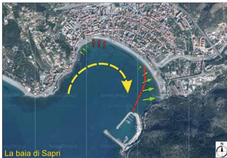
Figura 8 – La dinamica costiera in presenza del porto e di strutture "rigide" lungo litorale.
