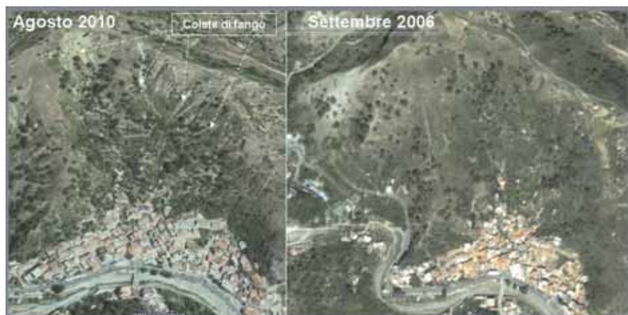
Figura 4 – Colate di fango verificatesi nel bacino a monte di Mili San Marco tra il 1 ottobre 2009 e il 10 marzo 2010. A destra è illustrata l'area di Mili San Marco (foto del 2006; a sinistra (foto dell'agosto 2010) sono evidenti le varie colate di fango che si sono innescate ed evolute lungo i ripidi versanti a monte dell'abitato riversandosi lungo le strade, tra il disastroso evento del 1 ottobre 2009 e quello del 10 marzo 2010.
