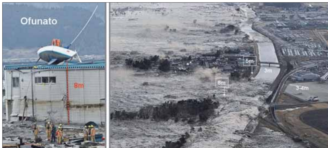
Figura 8 – Ricostruzione dell'altezza dell'acqua marina sul water front di Ofunato e nella pianura alluvionale nei pressi dell'aeroporto di Sendai.
