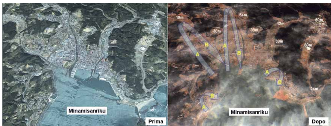
Figura 11: Devastante impatto (a destra) dell'acqua marina che ha invaso la città di Minamisanriku (a sinistra prima dell'evento). Il flusso di acqua e detriti è risalito fino a circa 50 metri di altezza (parte A delle frecce) per poi ritornare verso mare come un debris flow (parte B delle frecce).
