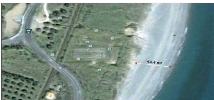
Figura 4 – La distanza fra battigia e duna, nonostante l'apporto di materiale solido dovuto agli effetti della cd. "alluvione di Soverato" si è ridotta a 44,4 m.
