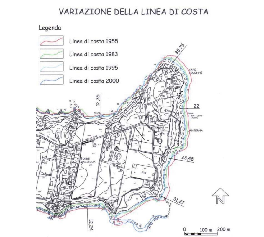
Figura 10 – Variazione della linea di costa fra il 1955 e il 2000 (da Lena et alii, 2003-04).
