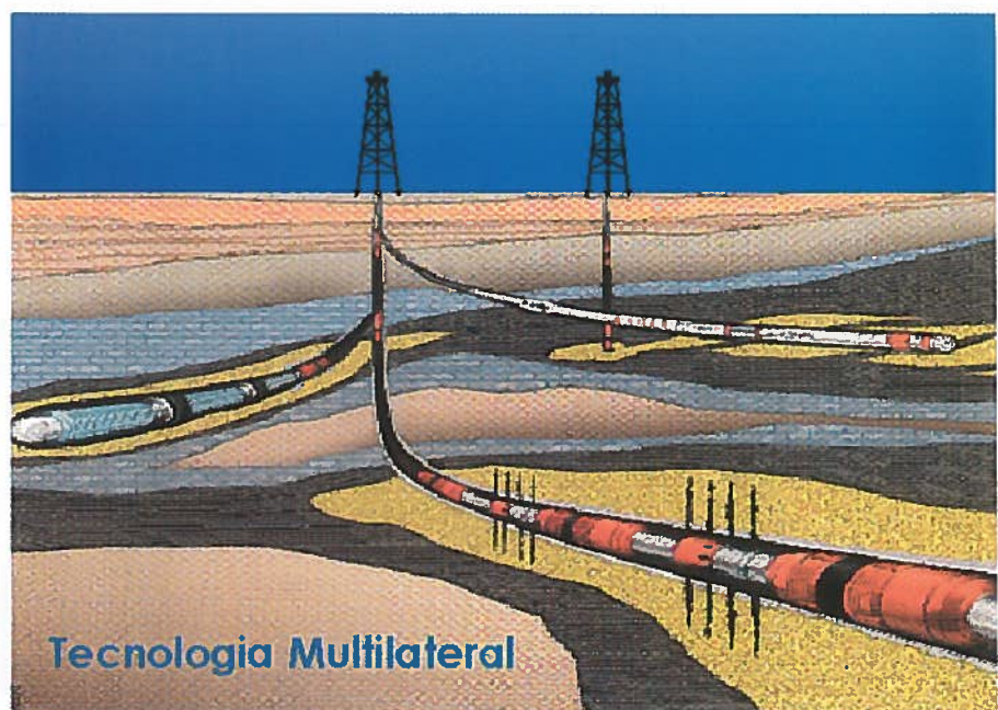
Figura 4 - Schema applicativo della tecnologia multilateral.
