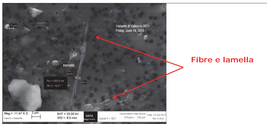
Figura 4 – Analisi SEM di campioni di roccia da scavo (fibre e lamelle/tozzetti)
