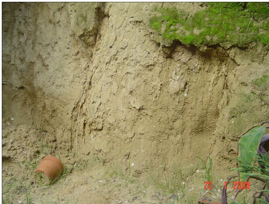
Foto 5. Sabbie limose sciolte di colore giallognolo, in affioramento nell'estrema porzione sud-ovest dell'abitato, in uno spiazzo posto tra i Cappuccini e l'abbeveratoio
