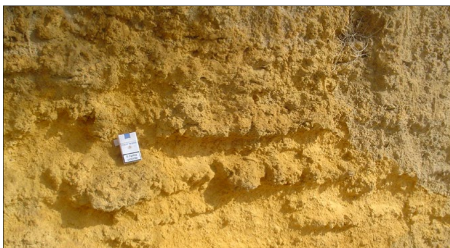
Foto 11. La disposizione stratigrafica delle sabbie e delle calcareniti esibisce profili teneri o tenacemente cementati che ben si esprimono con incavature e sporgenze in conseguenza delle diverse caratteristiche geotecniche dei due litotipi
