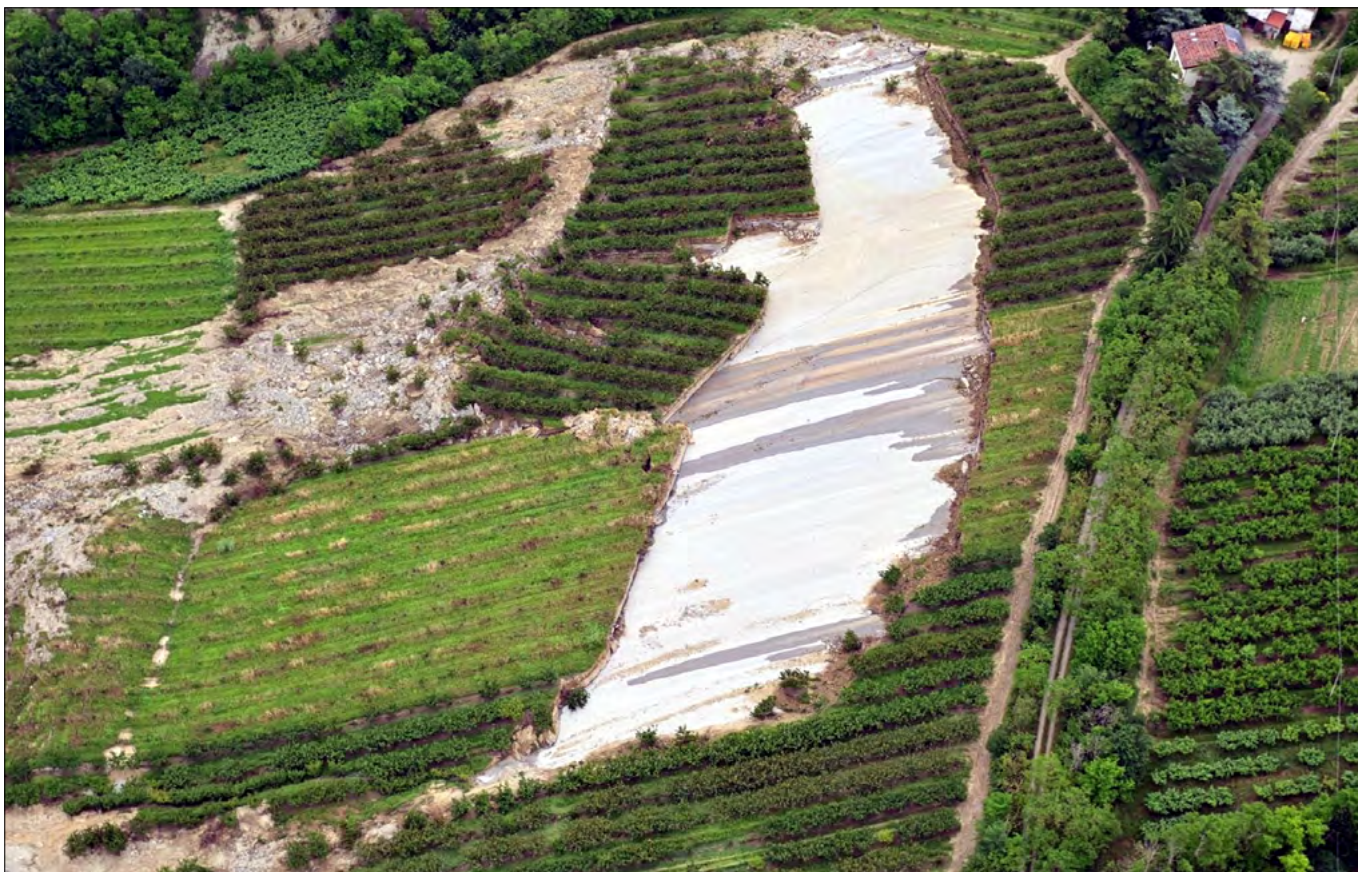
Figura 10. Borgo Tossignano (BO): scollamento di vigneti lungo un piano marnoso arenaceo (foto P. Fabbri)
