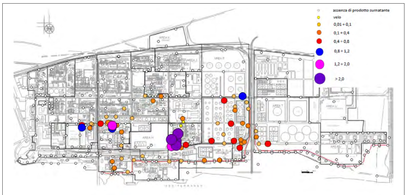
FIGURA 5. SIN Gela: spessore apparente del prodotto surnatante (Gennaio 2018).
