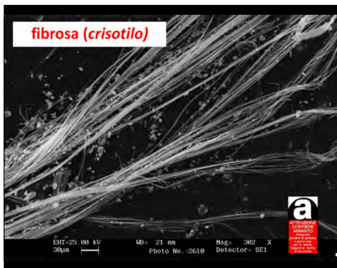
FIGURA 15. Differenze morfologiche fra fibre di amianto crisotilo e lamelle/prismetti di serpentino.
