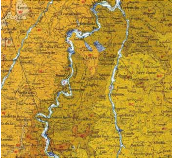
Fig. 3 - Inquadramento geologico: stralcio del Foglio 81 "Ceva" della Carta Geologica d'Italia alla scala 1:100.000 (Calderini et alii , 1970). L'itinerario proposto per la Pietra di Langa risale la Bormida di Millesimo da Cortemilia attraverso l'omonima Formazione ( M^{2-1} ) fino a Monesiglio ove affiora la relativa Formazione ( Mm^{2-1} ).
