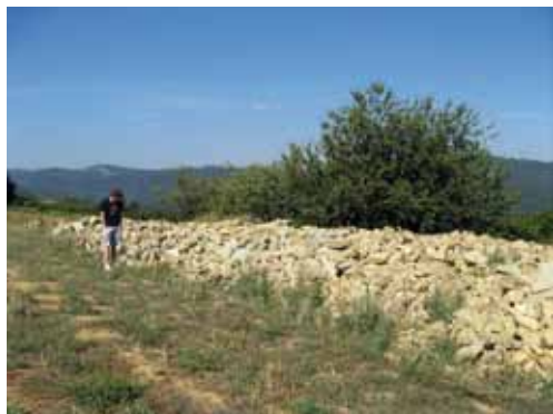
Fig. 5 - L'estrazione della Pietra di Langa non prevede la realizzazione di vere cave. I contadini, durante l'aratura, strappano dal suolo i blocchi di arenaria di varia grandezza e li accantonano al fondo dei campi.
