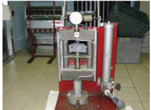
Fig. 8 - Apparato per la prova di resistenza al punzonamento (point load test) - Laboratorio di Caratterizzazione Tecnica delle Rocce - Dipartimento di Scienze della Terra - Università degli Studi di Torino.
