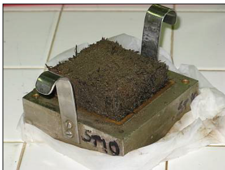
Figura A.7 - Campione di matre viva sottoposto a prova di taglio diretto (da F. Boccalaro, 2007)
