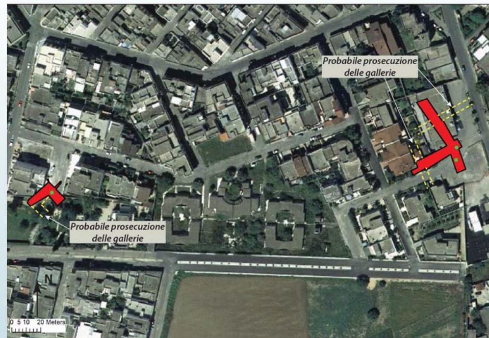
Proiezione in pianta su ortofoto del 2006 della Regione Puglia dei rilievi tridimensionali delle due cave ipogee rilevate nel centro urbano di Cutrofiano. Con le linee tratteggiate in giallo sono indicate le aree in cui si presume l'estensione delle gallerie delle cave ipogee.
