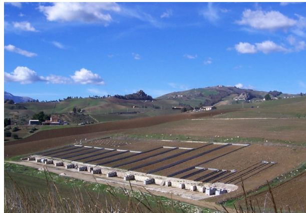
Installazione sperimentale di Sparacia per la misura dell'erosione idrica
