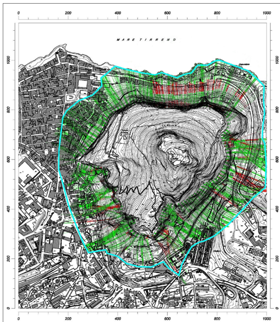
Figura 17. Traiettorie dei blocchi lapidei in caduta dalla Rocca e delimitazione dell'area vulnerabile presente a valle dei fronti rocciosi, in scala 1:5.000
