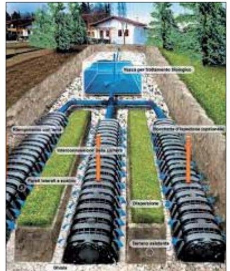
Figura 8 – Alcuni esempi di realizzazione di opere ai fini del complessivo raggiungimento dell'invarianza Idraulica
