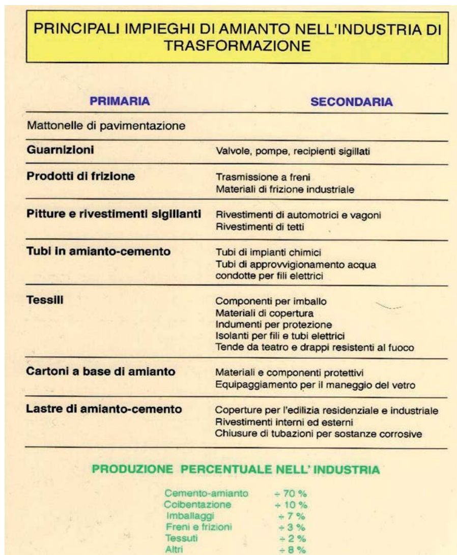
Figura 1 – Principali manufatti contenenti amianto
