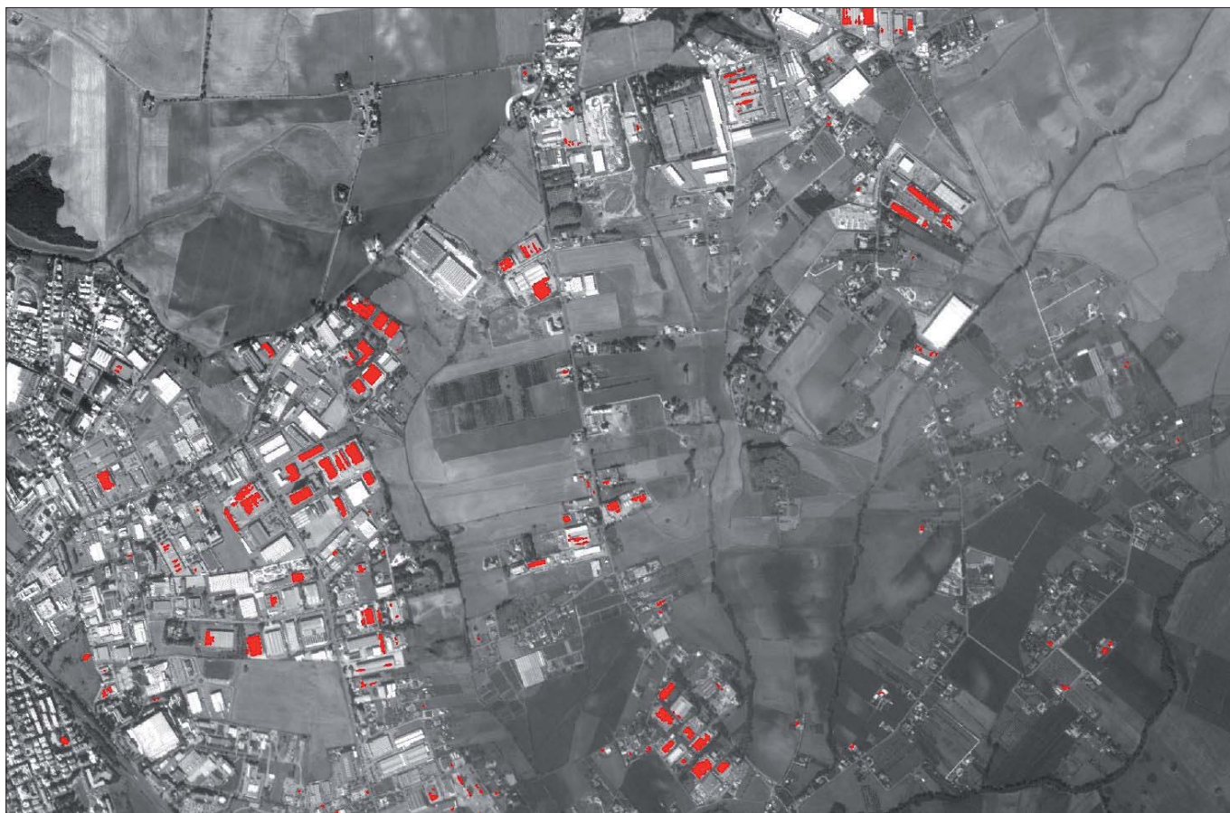
Figura 3 – Dettaglio della classificazione nell'area industriale di Pomezia. In colore rosso sono caratterizzate le sole coperture in cemento-amianto
