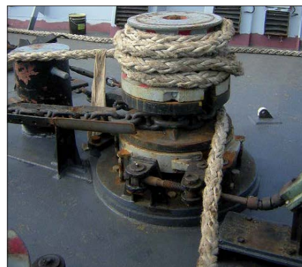
Figura 8 – Foto della Fregata Canopo, varata nel 1955, e radiata nel 1982. A destra, dettaglio dell'argano della nave Cassiopea, contenente amianto
