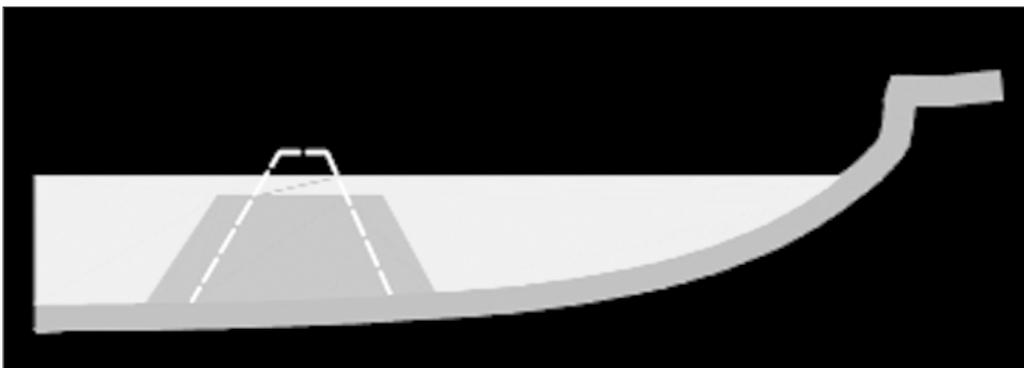
Figura10 - Schema di una sezione trasversale di diga frangiflutti distanziata sommersa.
