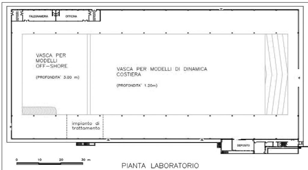
Figura 3 - Pianta delle vasche per la realizzazione dei Modelli Fisici.
