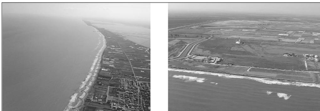
Figura 28 - Tratto del litorale a nord del porto di Margherita di Savoia: si notano le opere di protezione realizzate per contenere l'azione erosiva innescata dalla realizzazione del porto. Nella foto a destra, zona Ippocampo, si vedono aree allagate in concomitanza di un evento meteomarinico e idrologico.
