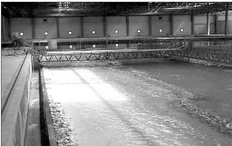
Figura 21 - Modello con la situazione attuale delle opere, si nota la risalita di acqua e sabbia sulla strada litoranea durante un attacco ondososo con  $H_s=4,5$  m nel prototipo.
