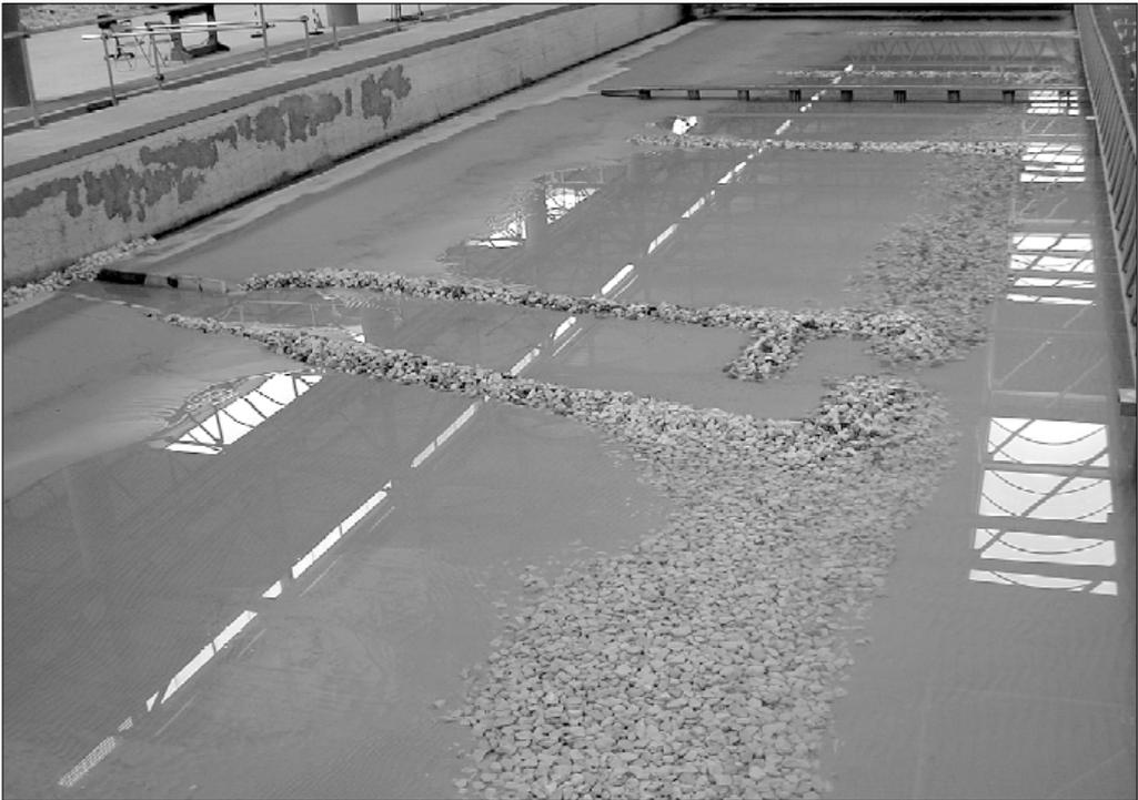
Figura 16 - Foto del modello con la configurazione attuale delle opere di difesa.
