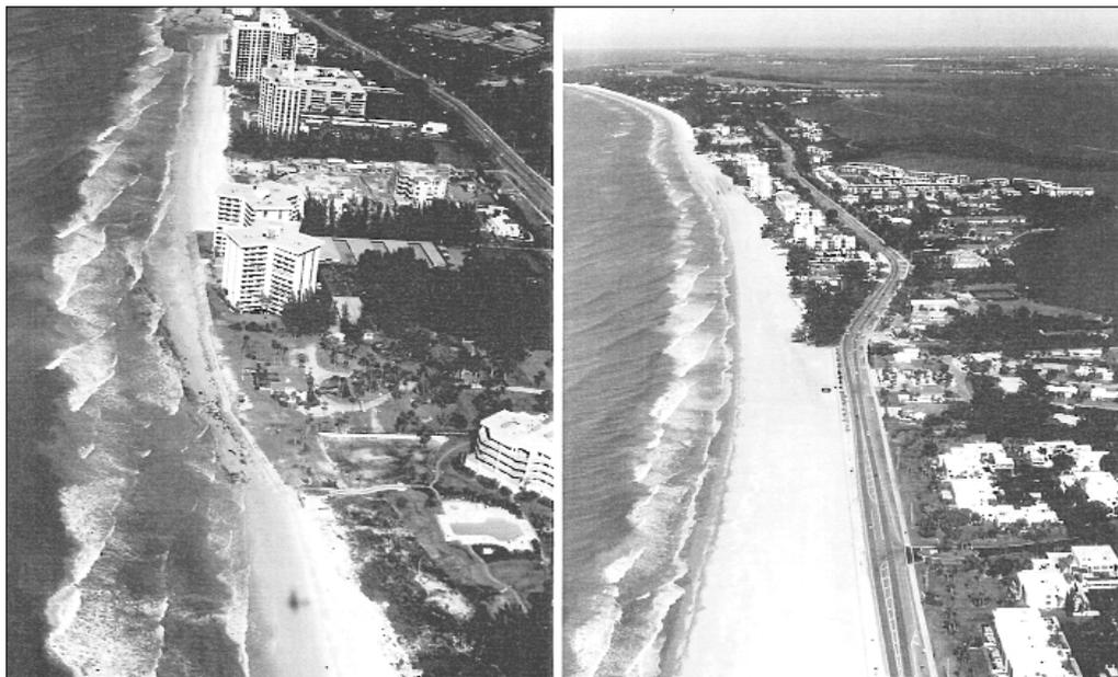
Figura 3 - Esempio dell'effetto di una azione di ripascimento di sedimento lungo un tratto di litorale californiano (da Finkl & Walker, 2006).
