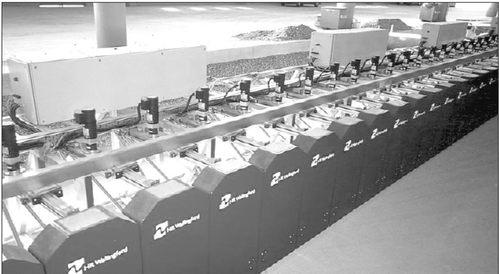
Figura 4 - Generatore di moto ondoso per Modelli Fisici 3D.
