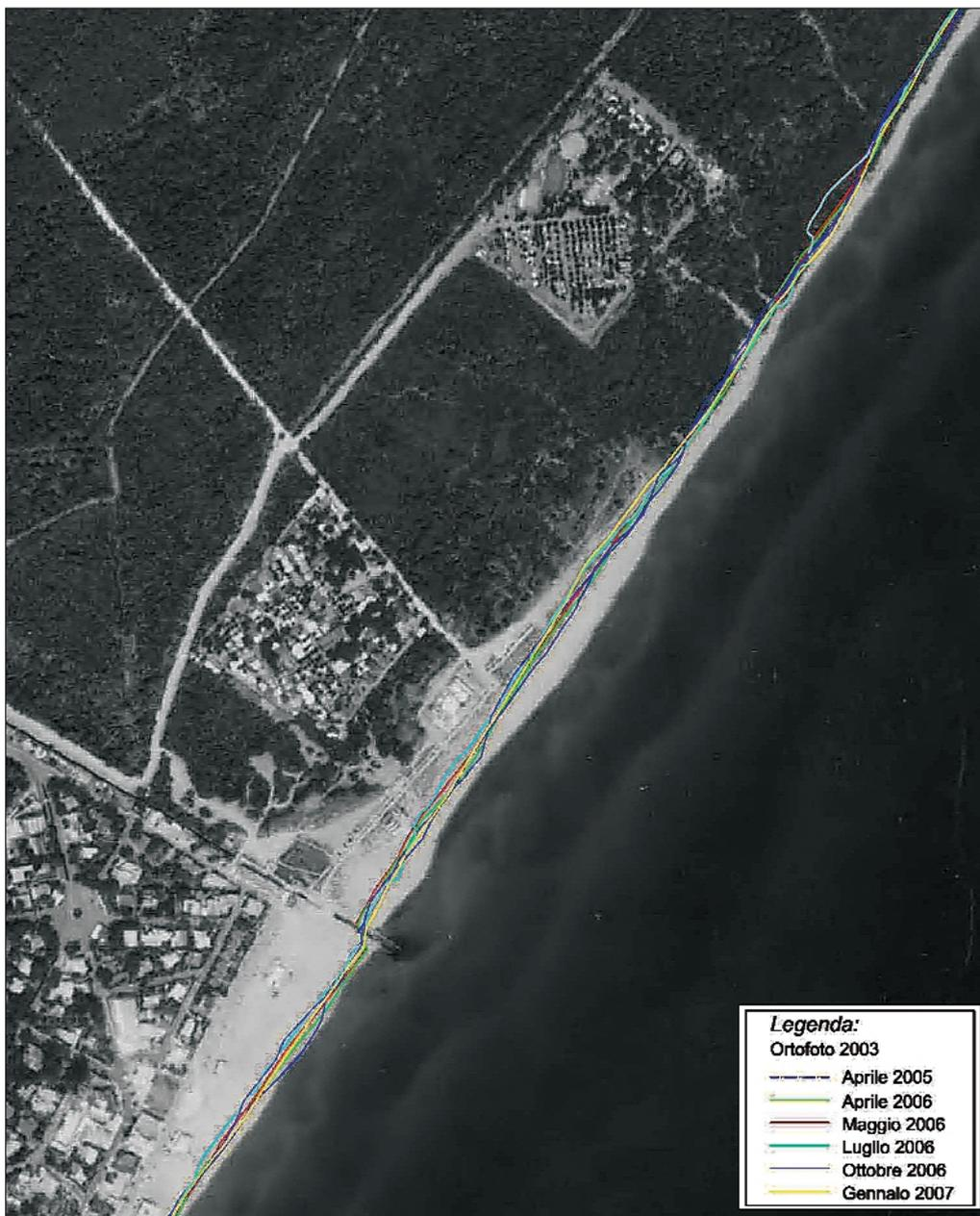
Figura 3 - Evoluzione della linea di costa mediante misure periodiche di precisione con GPS con compensazione della marea.
