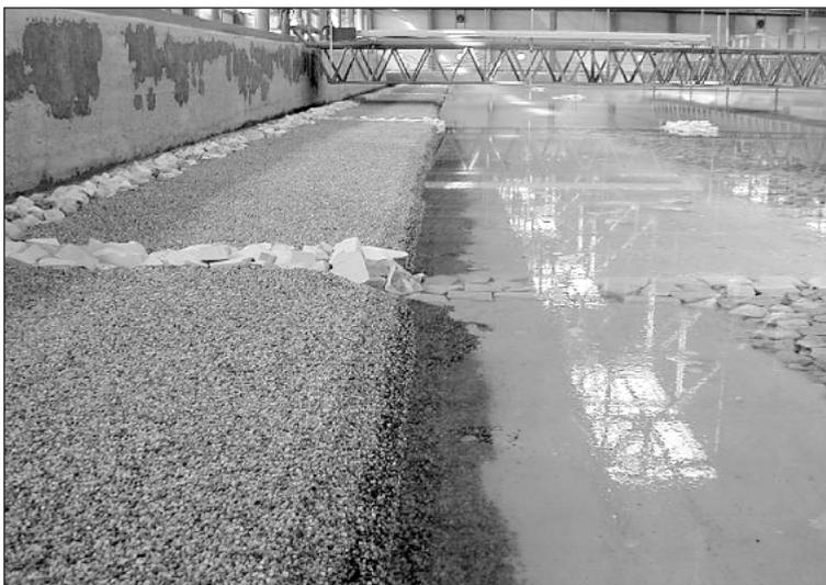
Figura 22 - Modello con la configurazione progettuale: ripascimento con ghiaia con diametro medio di 3 - 4 cm, nel prototipo; si nota il ripascimento, la presenza di sette sommersi ed emersi per il contenimento delle ghiaia e l'abbassamento delle scogliere emerse. Dalla foto è evidente la riqualificazione ambientale che si ha con le opere previste in progetto.
