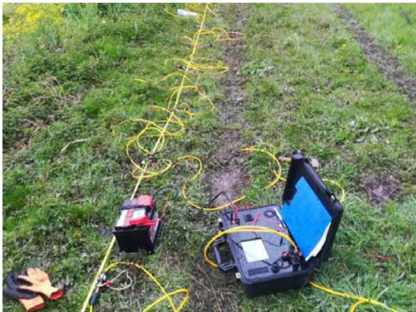
Fig. 103. Il metodo geoelettrico. La strumentazione con gli elettrodi fissati al suolo.
