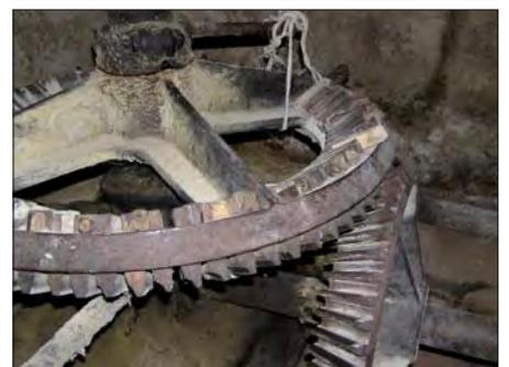
Figura 12 – Vano macinazione. Gli ingranaggi: l'asse orizzontale ruota per impulso della cinghia di trasmissione e mediante le ruote dentate viene azionato un asse verticale, collegato alle macine.
