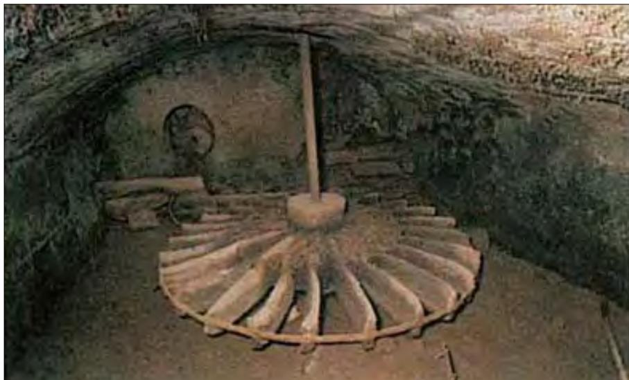
Figura 3 – La ruota lignea ha le pale a superficie concava.
