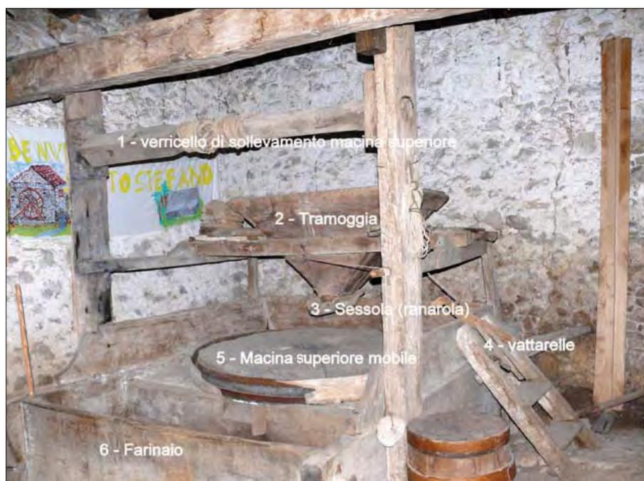
Figura 12 – Interno del Mulino.
