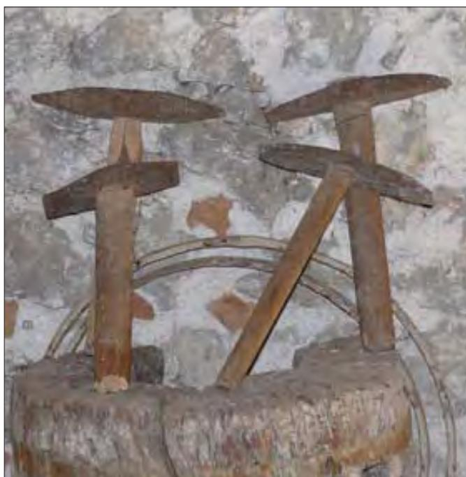
Figura 9.1 – Martelle, ricostruite, utilizzate per la ribattitura delle macine.
