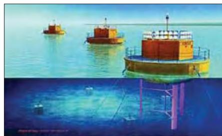
Figura 9 – Primo impianto pilota per sfruttare le correnti marine, costruito nello Stretto di Messina.
