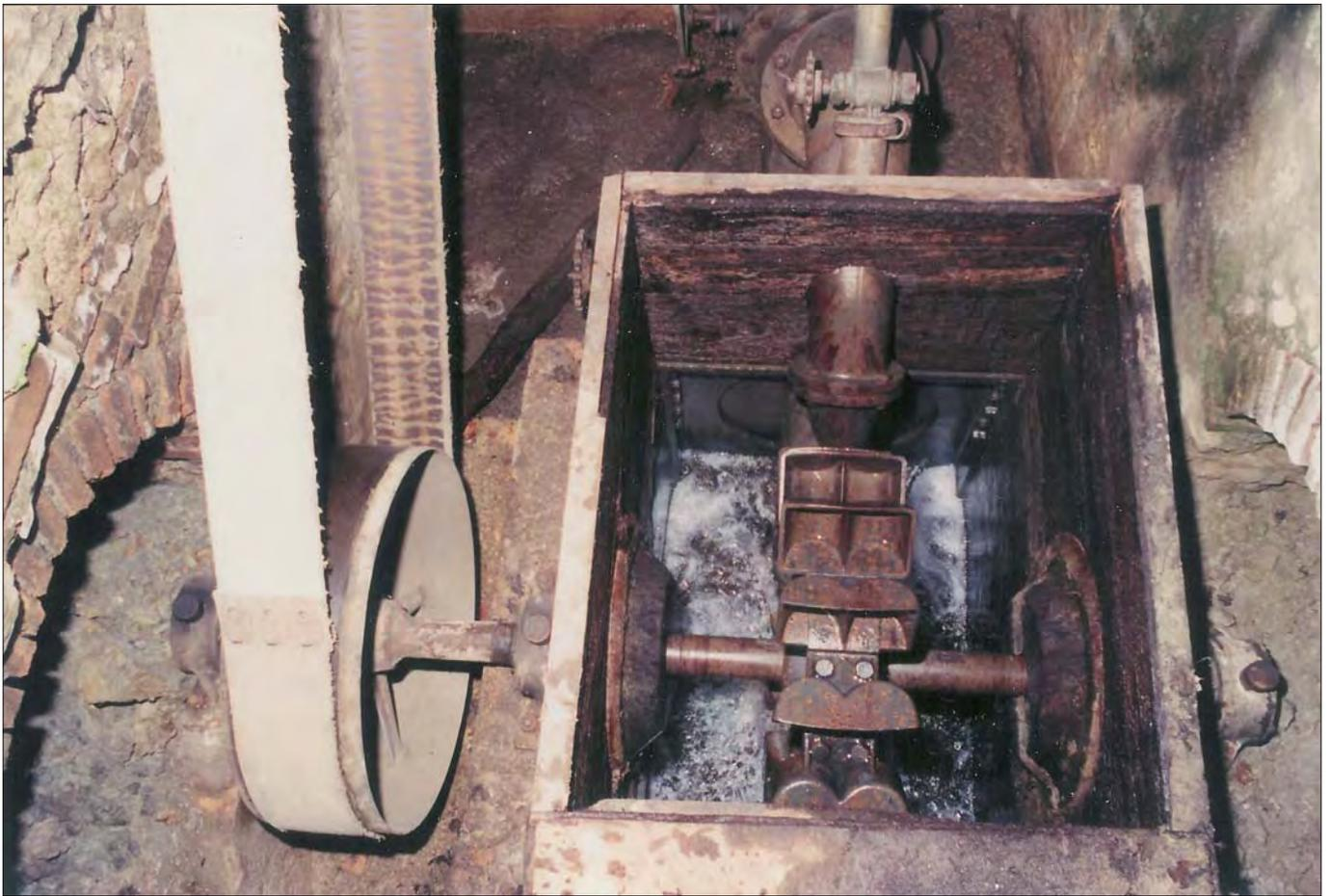
Figura 10 – Turbina "Pelton" verticale, con asse orizzontale, puleggia, cinghia di trasmissione.
