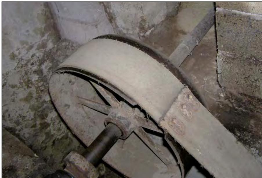
Figura 11 – La cinghia di trasmissione proveniente dal piano inferiore, dove è stata messa in moto dalla turbina, mette in azione un asse orizzontale nel piano superiore.
