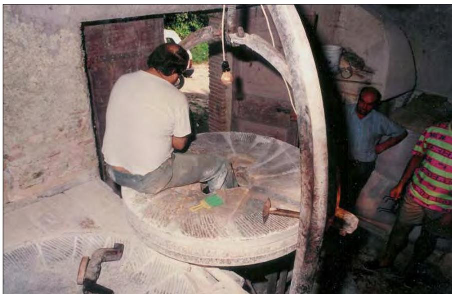
Figura 14 – Nel mulino De Angelis periodicamente avviene la "ribattitura", ossia un operaio specializzato mediante appositi scalpelli rinvigiva i solchi necessari affinché avvenisse uno sfregamento efficace fra le due superfici abrasive della macine.
