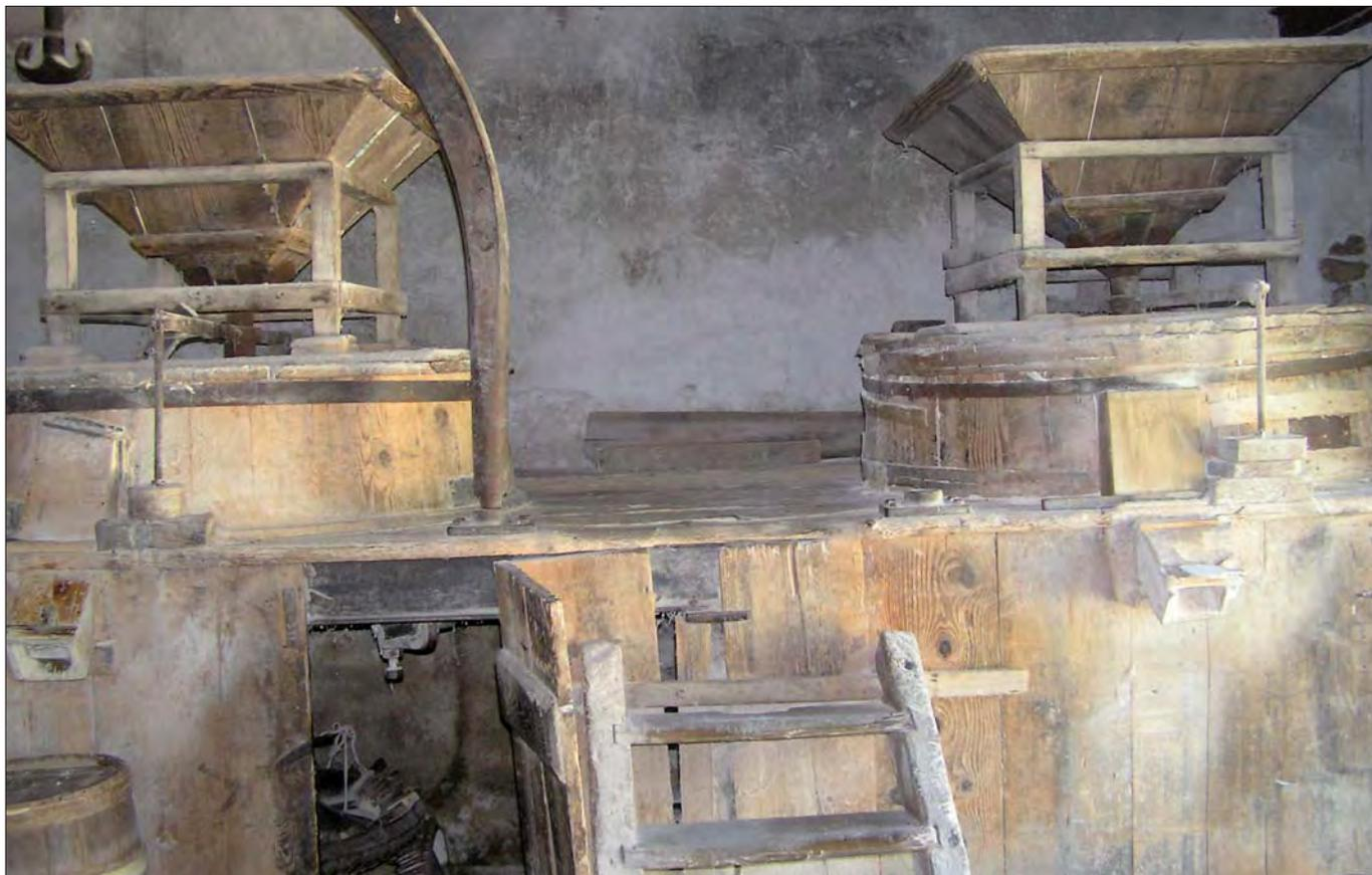
Figura 13 – Le tramogge sono due nel caso del mulino De Angelis. Sotto le tramogge ci sono le macine, riparate per non far sfuggire la farina. Al di sotto di una tramoggia si intravedono gli ingranaggi.
