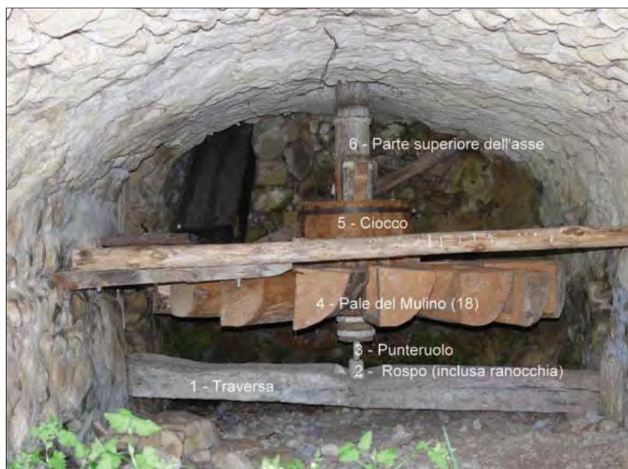
Figura 10 – La nuova turbina del mulino con evidenziate le parti principali.
