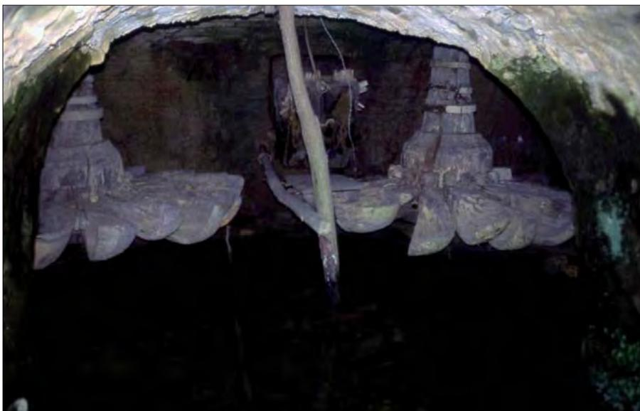
Figura 9 – Ruote idrauliche in legno.
