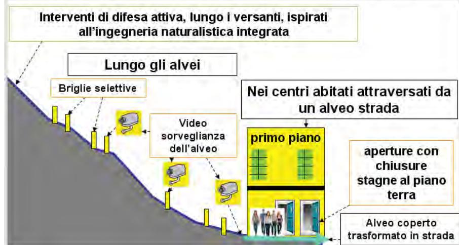
Figura 23 – Schema degli interventi di difesa attiva e passiva realizzabili per mitigare gli effetti sull'ambiente naturale e urbanizzato e per garantire la sicurezza dei cittadini.
