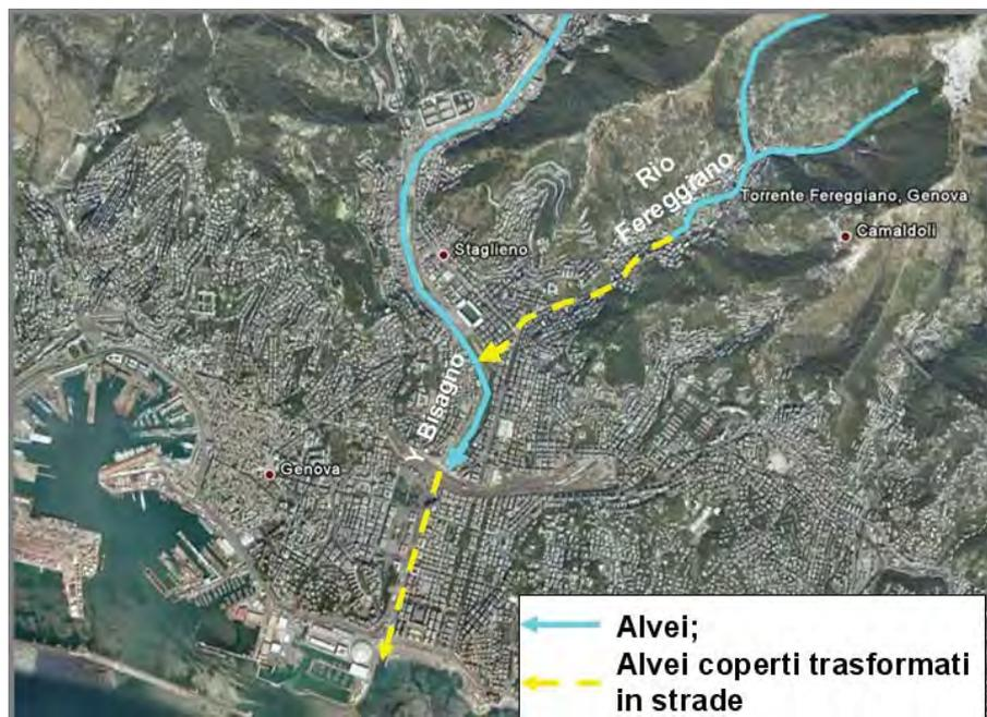
Figura 17 – Inquadramento ambientale. Il Rio Fereggiano è un affluente in sinistra idrografica del Torrente Bisagno. Un tratto di circa 1500 m del Rio Fereggiano e il tratto terminale del T. Bisagno sono stati trasformati in strade mediante copertura degli alvei.
