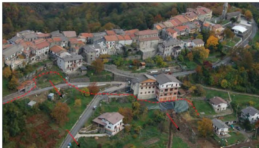
Figura 5 – Coronamento della grossa frana di Montereaggio visto dall'elicottero.
