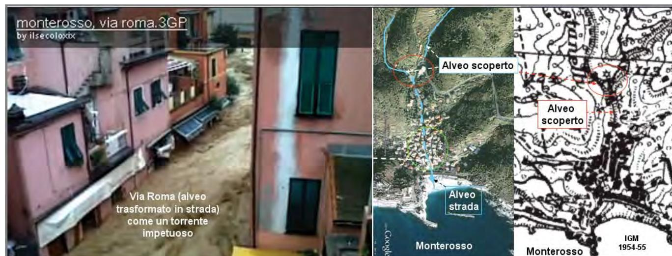
Figura 10 – A destra l'abitato di Monterosso nel 1954-55 quando l'alveo era ancora in gran parte scoperto. Al centro: l'alveo trasformato in alveo-strada (chiamata via Roma) che è stato devastato dal flusso fangoso (immagine a sinistra) che si è riappropriato dell'area di sua competenza (immagini a sinistra tratte dalla rete, Secolo XIX).
