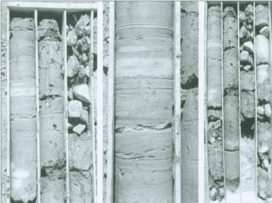
Figura 3 – Strato metrico di limo argilloso intercluso nella ghiaia con estensione areale pluridecamentrica.
