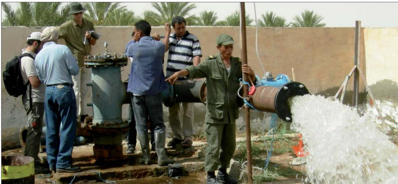
Figura 11 – Esecuzione di una prova di portata artesianiana con tubo a diaframma su un pozzo di Redjem Maatoug (Fonte: De Vito et al., 2009)
