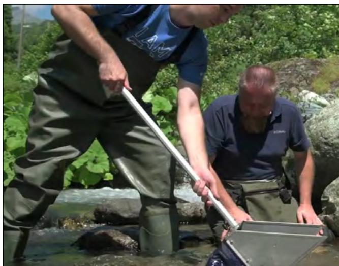
FIGURA 7. Utilizzo della rete SURVER per campionare i macroinvertebrati bentonici in un tratto di fondo fluviale.
