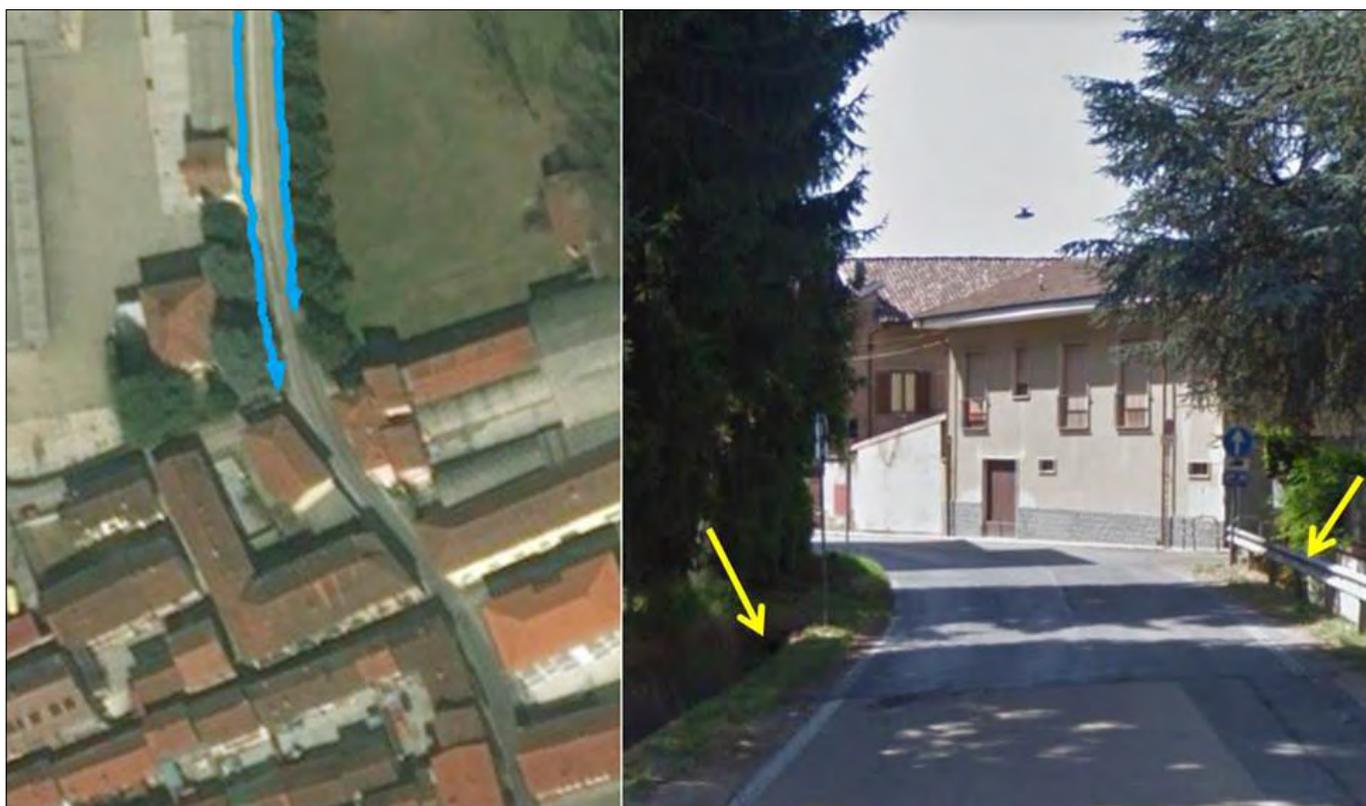
FIGURA 8. Sezione 3 – Canale: all'incrocio tra Via Ciriagno e Via alle Fornaci, tutta l'acqua proveniente dal bacino posto immediatamente a nord del paese (0,92 km<sup>2</sup>) si intuba nei punti indicati dalle frecce per almeno 280 m sotto l'abitato prima di raggiungere il T. Borbore.
