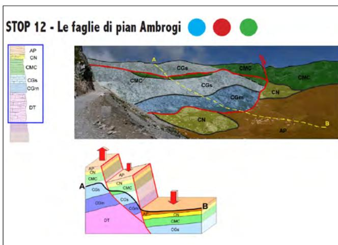
FIGURA 7. Dallo Stop 12 è possibile osservare l'espressione superficiale di due faglie normali molto inclinate. La foto panoramica è stata "vestita" per facilitare il riconoscimento degli elementi geologici nel paesaggio. Lo schema grafico illustra in tre dimensioni la cinematica delle faglie e gli effetti su geometrie e disposizione degli ammassi rocciosi.
