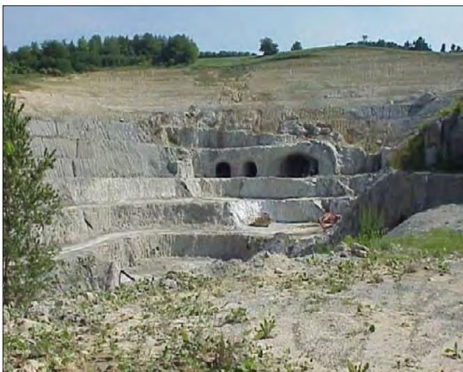
FIGURA 2. Cava di gesso di Cocconato. La coltivazione a cielo aperto è sviluppata in corrispondenza di una preesistente cava in sotterraneo.
