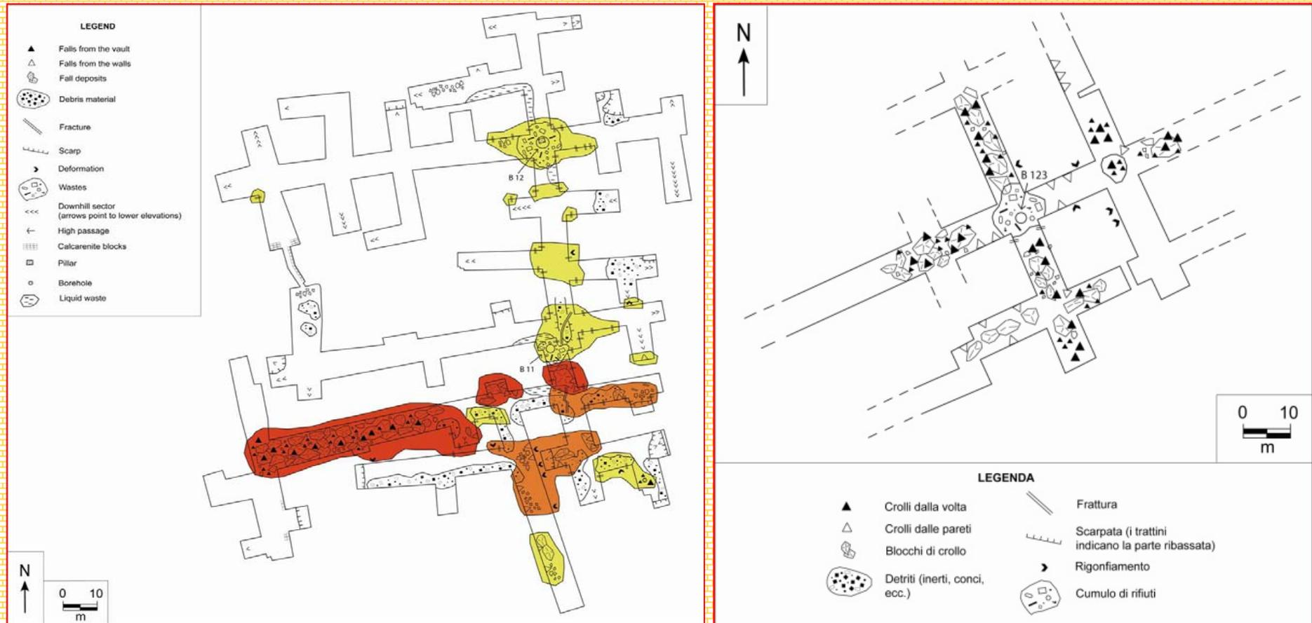
Planimetrie delle cavità sotterranee di Cutrofiano, con schema di cavatura secondo gallerie ortogonali
